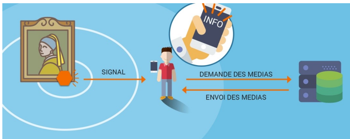
FIG. V.17 : Schéma du fonctionnement de la technologie beacon (crédits Ubidreams).
