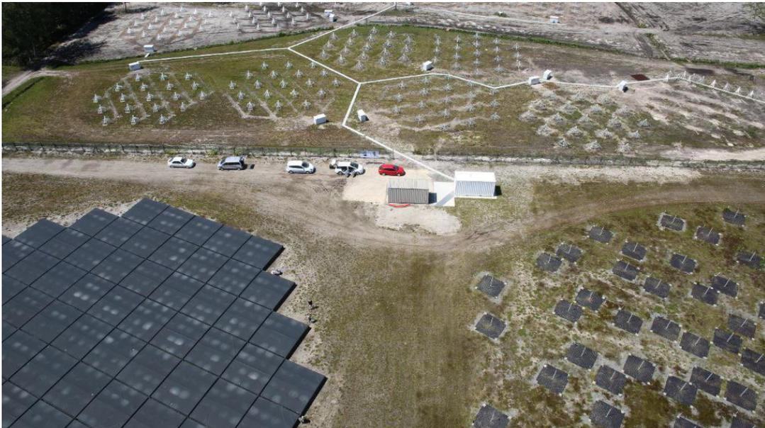
FIGURE 6.5 – Photographie aérienne de la station internationale LOFAR de Nançay (FR606) avec les antennes LBA en bas à droite, HBA en bas à gauche, ainsi que NenuFAR dans la partie haute. L'image provient de <https://www.obs-nancay.fr/-NenuFAR-45-.html>.
