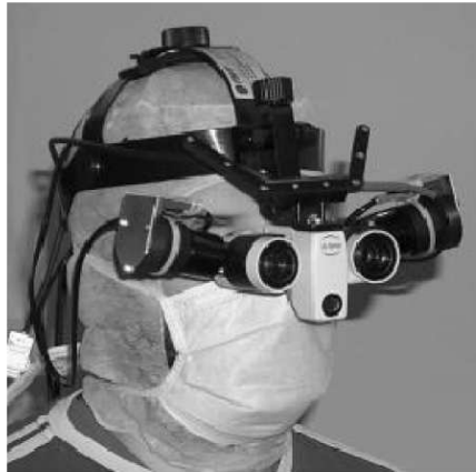
FIG. 2.11 – Le Varioscope. Ce casque de RA à visualisation optique est également un microscope chirurgical. La base de visualisation est réelle et vidéo et les informations virtuelles ajoutées de manière stéréoscopique sont 3D et correspondent au modèle patient. Illustration tirée de [BFM + 03].
