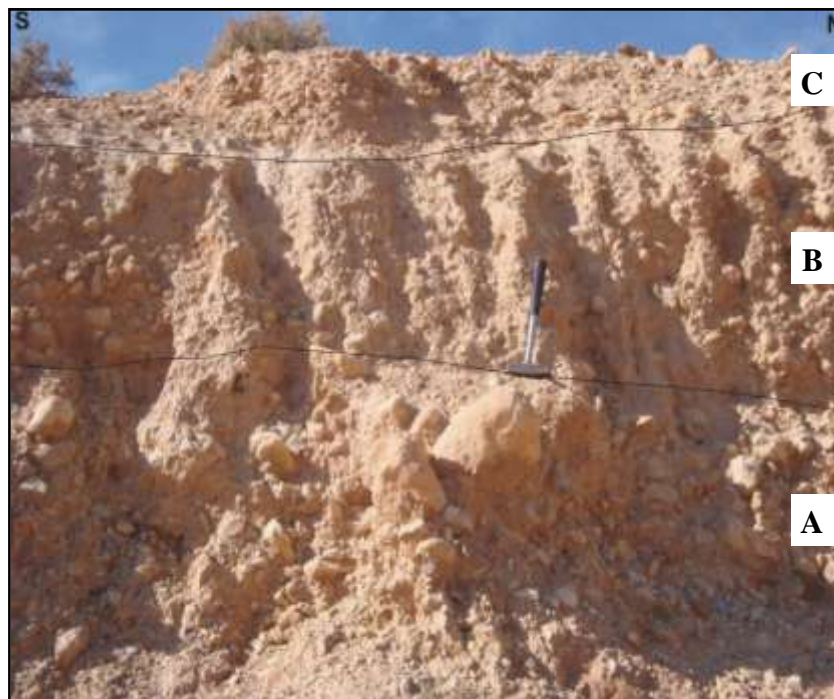
Photo n°. 35: Coupe montrant le dépôt du cône de déjection C2 de l'oued Aj-Jmal
