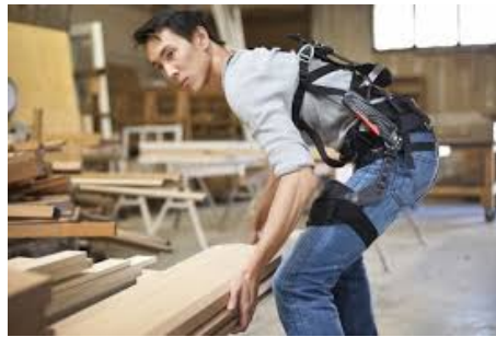
FIGURE 2.5 – Exosquelette BackX par SuitX 4 . Cet exosquelette permet de réduire les efforts exercés sur le bas du dos de l'opérateur. Photo issue du site de SuitX.
