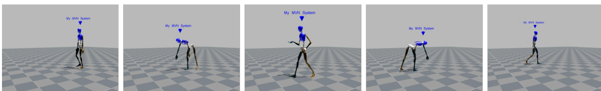
FIGURE 3.4 – Vue du logiciel MVN d'Xsens : Tâches de Pick & Place en laboratoire. Activités de gauche à droite : Wait, Pick, Carry, Place, Walk.
