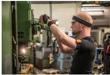
FIGURE 2.6 – Capteurs portés pour l'ergonomie. L'opérateur est équipé de capteurs inertiels Xsens 5 (en orange) sur les différentes parties du corps, ce qui permet la capture de ses mouvements. Photo issue du site de Xsens.
