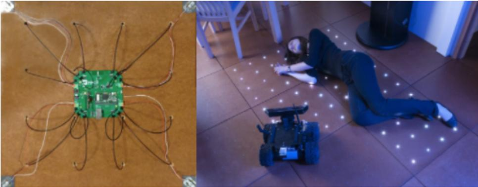
Les dalles de pression font partie de l'appartement intelligent, une plateforme de recherche au Loria. Le sol est couvert de dalles (plus de 60) équipées de capteurs de pression qui sont utilisées pour suivre le centre de pression d'une personne se déplaçant dans cet espace (Andries *et al.*, 2015).
