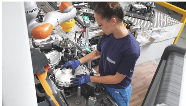
FIGURE 2.4 – Cobot Kuka 3 en travail collaboratif sur une ligne d'assemblage. Photo issue du site de Kuka.
