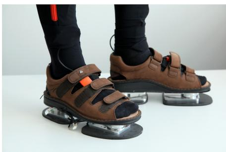
Les chaussures de force sont un prototype créé par l'*Istituto Italiano di Tecnologia* (IIT)<sup>9</sup> dans le cadre du projet AnDy. Elles sont chacune équipées de deux capteurs de force : le premier au niveau du talon, le second au niveau de la plante du pied. Les informations des deux capteurs sont combinées pour mesurer la force de réaction avec le sol sans la contrainte de placement des plateformes de force. Les données sont enregistrées à une fréquence de
