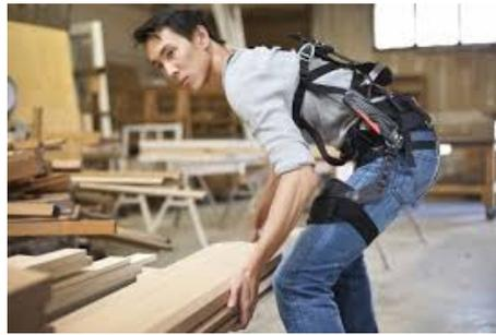
FIGURE 2.5 – Exosquelette BackX par SuitX<sup>4</sup>. Cet exosquelette permet de réduire les efforts exercés sur le bas du dos de l'opérateur. Photo issue du site de SuitX.
