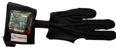
Un prototype de gant e-glove par Emphasis Telematics<sup>10</sup> est utilisé pour la main droite. Il comprend trois capteurs de flexion pour l'index, le majeur et le pouce, et quatre capteurs de pression sur la paume, et le bout de l'index, du majeur et du pouce. Les capteurs de flexion mesurent l'angle entre la paume et la dernière phalange du doigt. Les données sont enregistrées à une fréquence de 50 Hz.
