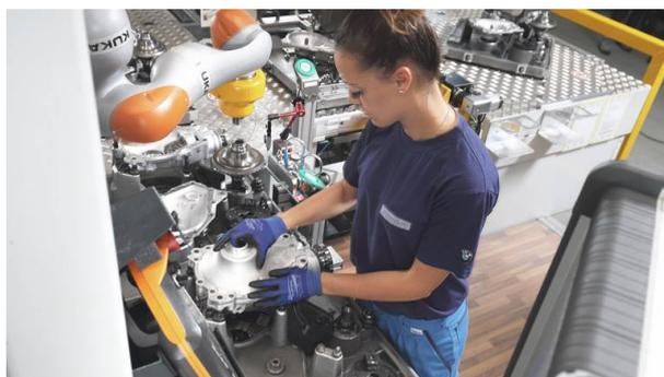
FIGURE 2.4 – Cobot Kuka<sup>3</sup> en travail collaboratif sur une ligne d'assemblage. Photo issue du site de Kuka.
