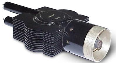
FIGURE 1.4: Magnétron provenant d'un radar russe.
