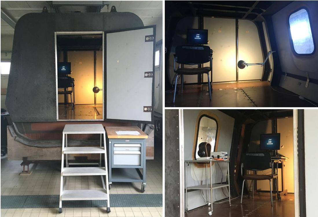
Figure 20 : Tronçon d'hélicoptère VASCO de l'ONERA Toulouse avec le dispositif expérimental. A gauche est présenté une vue extérieure du tronçon. A droite, une vue intérieure avec le bureau sur lequel les participants réalisaient les expériences.
