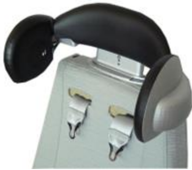
Figure 6 : Prototype d'appui-tête actif développé par Airbus Helicopters (d'après Macchi, 2015)
