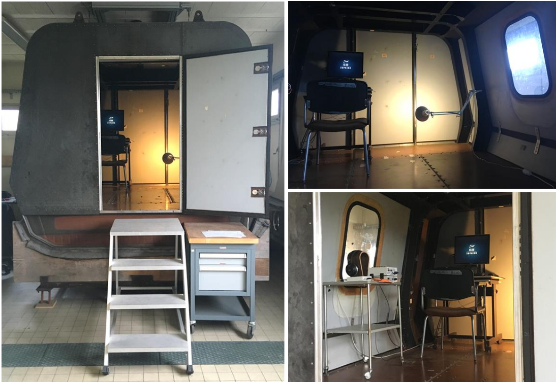
Figure 20 : Tronçon d'hélicoptère VASCO de l'ONERA Toulouse avec le dispositif expérimental. A gauche est présenté une vue extérieure du tronçon. A droite, une vue intérieure avec le bureau sur lequel les participants réalisaient les expériences.
