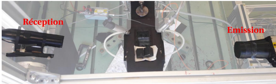
Figure 3-1 Photographie de la configuration optique du système PDA implémenté sur le banc MERCATO. Vue de dessus du banc : la réception et l'émission se font face et sont placées devant les hublots latéraux de la chambre de visualisation.
