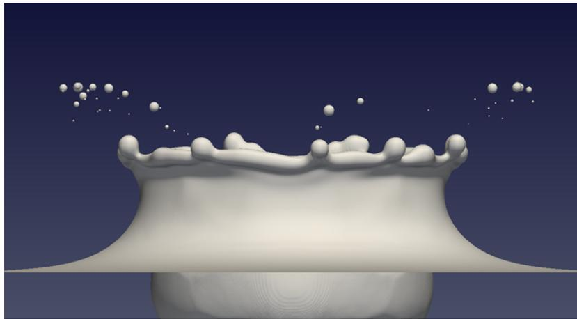
FIGURE 49 – Simulation sur quart de goutte, maillage  $512^3$ ,  $\Delta = 30 \mu m$ ,  $\Delta^* = 127$  cellules par diamètre initial de goutte. 512 cœurs de calculs, 150.000 h.cpu.
