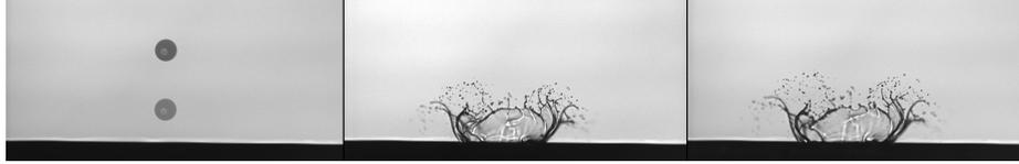
FIGURE 58 – Données type enregistrées lors d’un impact. Deux images séparées de  $\Delta t \sim 40 \mu s$  avant l’impact sont fusionnées en une seule image pour l’analyse. Une seconde paire d’images est prise après un délai ajustable ( $\Delta t \sim 50 \mu s$ ). Le délai séparant ces deux dernières images est limité par l’intervalle entre deux *flash* successifs, de l’ordre de  $\Delta t \sim 5 \mu s$ .
