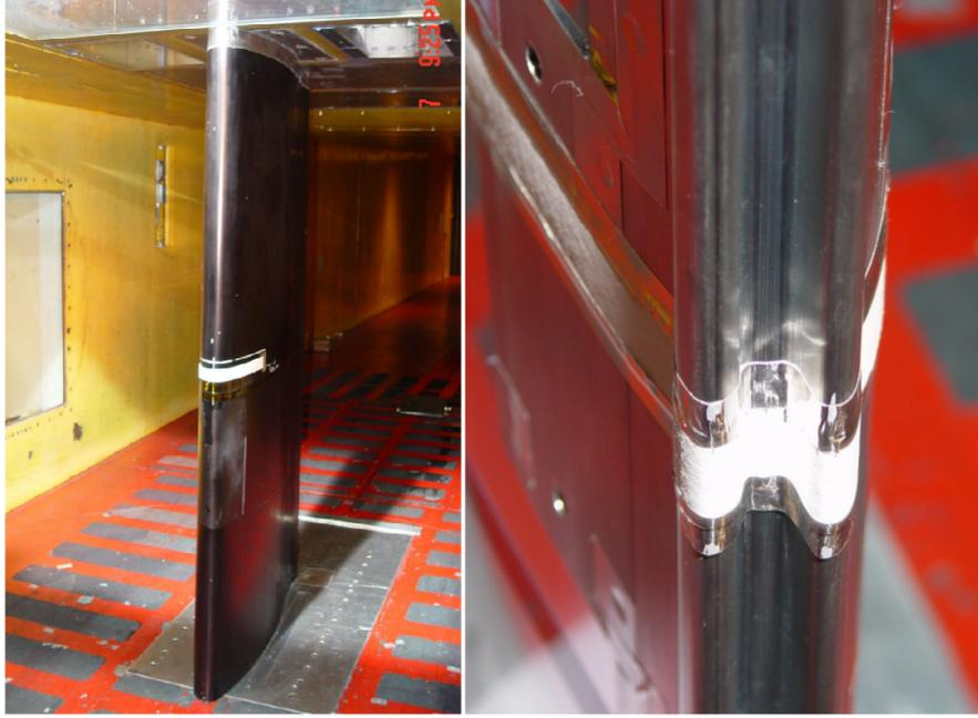
FIGURE 24 – Profil d’aile placé dans la veine d’essai. A gauche, profil propre. A droite : vue rapprochée du bord d’attaque d’un profil d’aile équipé d’une forme de glace en corne. Figure tirée de [78].
