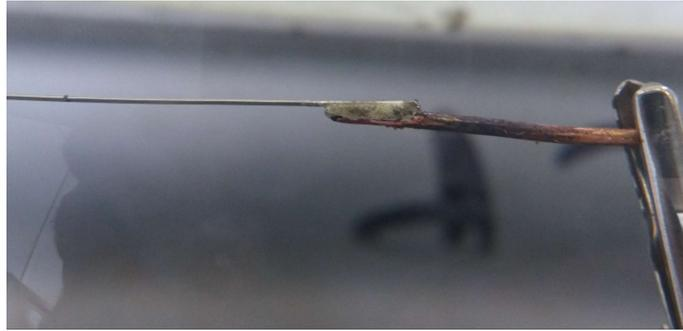
Figure 29 : Brasure à l'argent du fil de chromel sur un fil de cuivre
