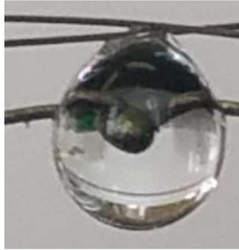
Figure 16 : Thermocouple de 200  $\mu\text{m}$  placé au centre d'une goutte
