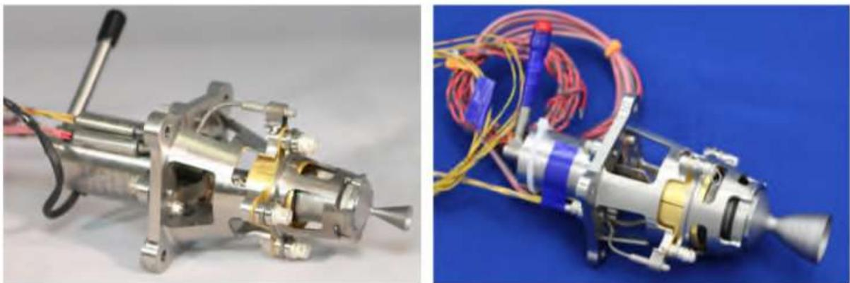
Figure 1: Propulseurs GPIM GR1 (gauche), GR22 (droite) (21)
