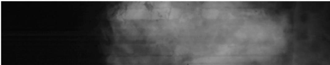
Figure 65 : Observation de la flamme avec une caméra Phantom V711 et un filtre IR>800 nm (temps d'exposition 25  $\mu$ s)
