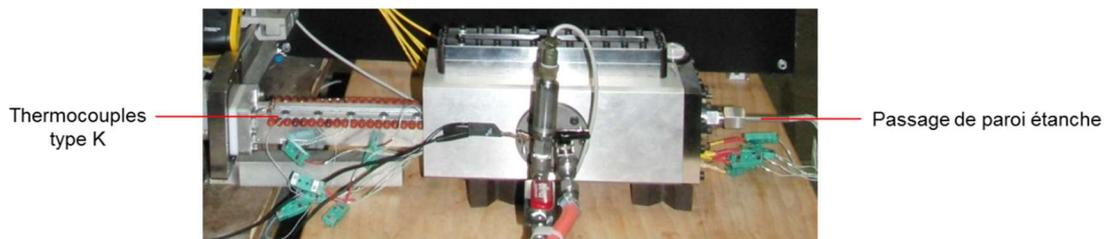
Figure 67 : Positionnement des thermocouples dans la gouttière
