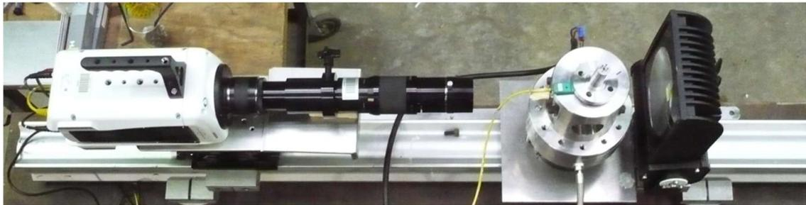
Figure 31 : Montage expérimental de l'observation de la décomposition d'une goutte isolée
