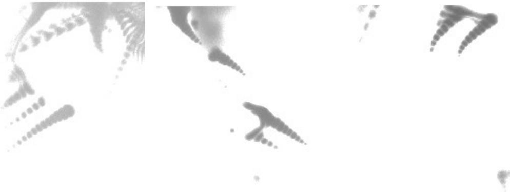
Figure 35 : Somme des minima d'intensité pour des gouttes en combustion à 11,5 bar
