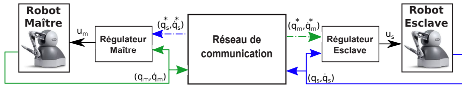
Figure 4.3 – Architecture du système télé-opéré
