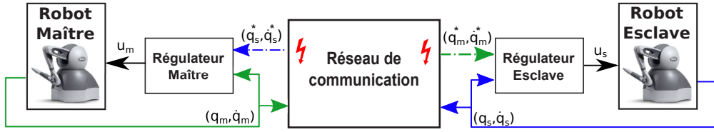
Figure 4.4 – Architecture du système télé-opéré
