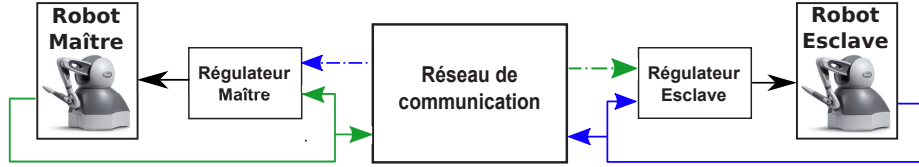
Figure 4.2 – Système téléopéré communiquant à travers un réseau de communication
