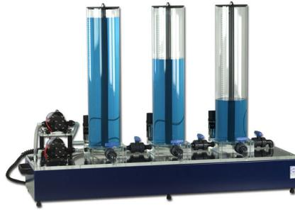
FIGURE 3.3 – Maquette de la société AMIRA pour la régulation de niveaux d'eau
