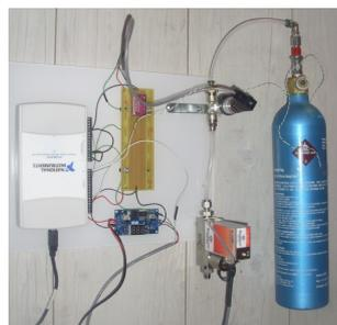
FIGURE 6.20 – Banc d'essai pour le stockage d'hydrogène au laboratoire IMS
