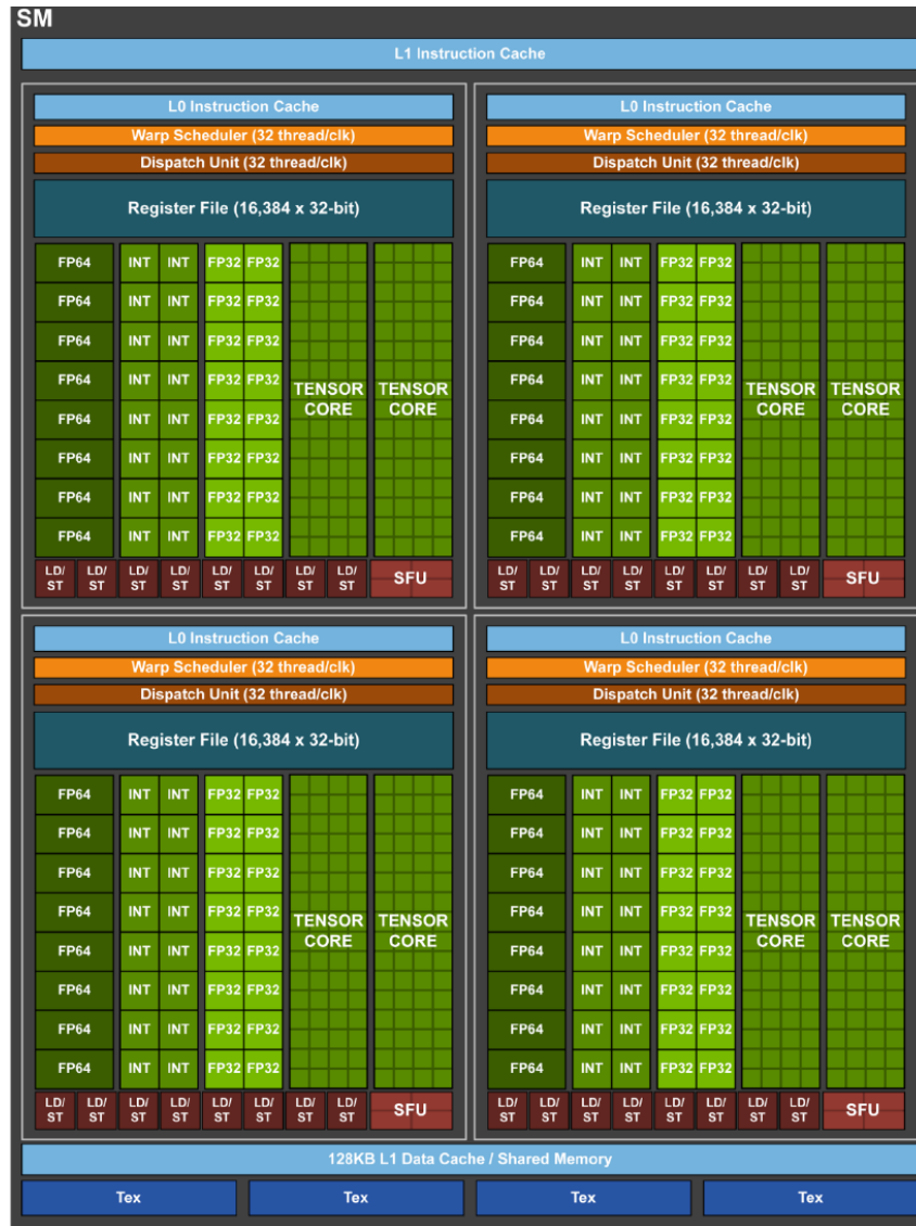
FIGURE 3.7 – Détail de l'architecture d'un SM (Symmetric Multiprocessor) du GPU Volta de 2018. L'aspect symétrique de cette architecture apparaît clairement. Ce qui est nouveau par rapport à la génération des GPUs de Titane est l'apparition des unités de calcul FP64, inexistantes dans les S1070, et des « tensor core » spécialement conçus pour accélérer les calculs d'intelligence artificielle (IA).
