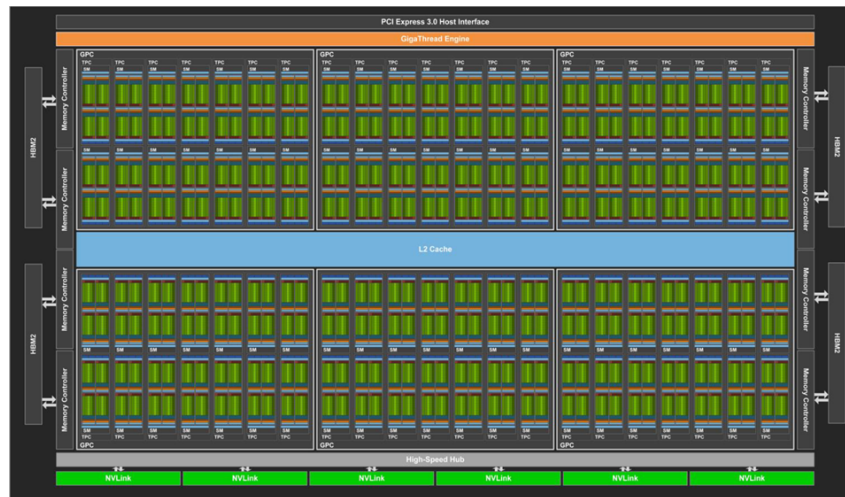
FIGURE 3.6 – Le GPU de dernière génération de chez NVIDIA : le Volta sorti en 2017. La régularité de la conception de cette carte graphique est évidente. Un zoom sur les unités fonctionnelles la composant est donné en figure 3.7.
