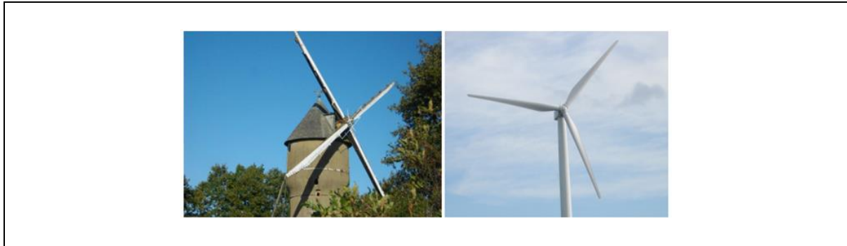
Figure 1.8 Éoliennes à axe horizontal
