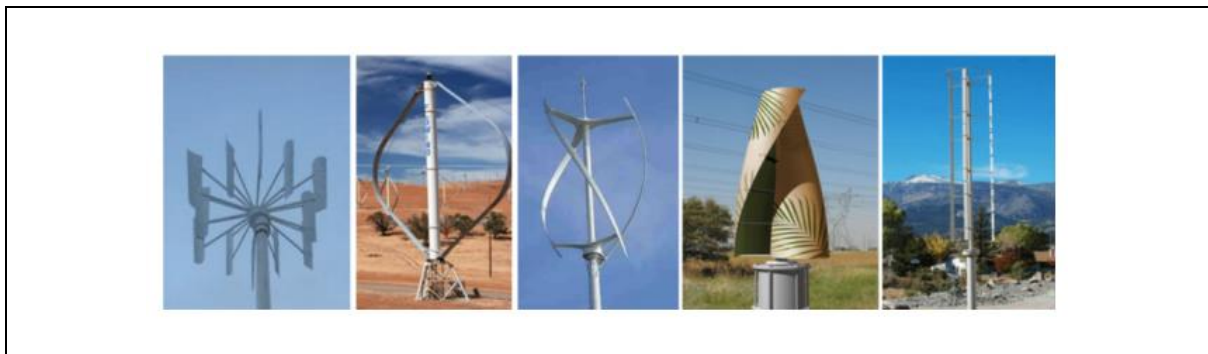
Figure 1.9 Éoliennes à axe vertical
