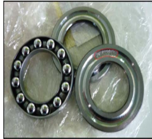
(b) Butée à billes à simple effet (SNR 51207). Mise en évidence de l'écailage
