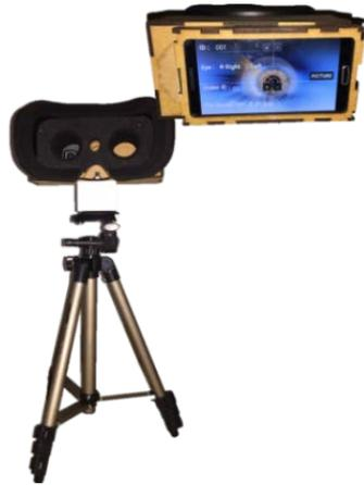
Figure 4.1 Iriscope utilisé pour l'acquisition de l'iris dans le spectre visible
