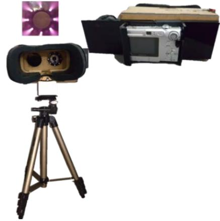
Figure 4.2 Iriscope utilisé pour l'acquisition de l'iris dans le PIR
