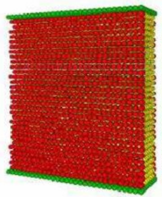
FIGURE 1.14 – Maillage d'éléments discrets constitués de boules non-jointives 4
