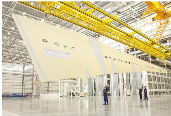
Figure 1.1 – Couvercle inférieur ou peau d'une aile du programme A350 (source Airbus)
