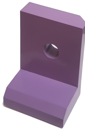
Figure 4.8 – Réalisation du composant interface actualisé à l'aide d'un procédé de fabrication additive
