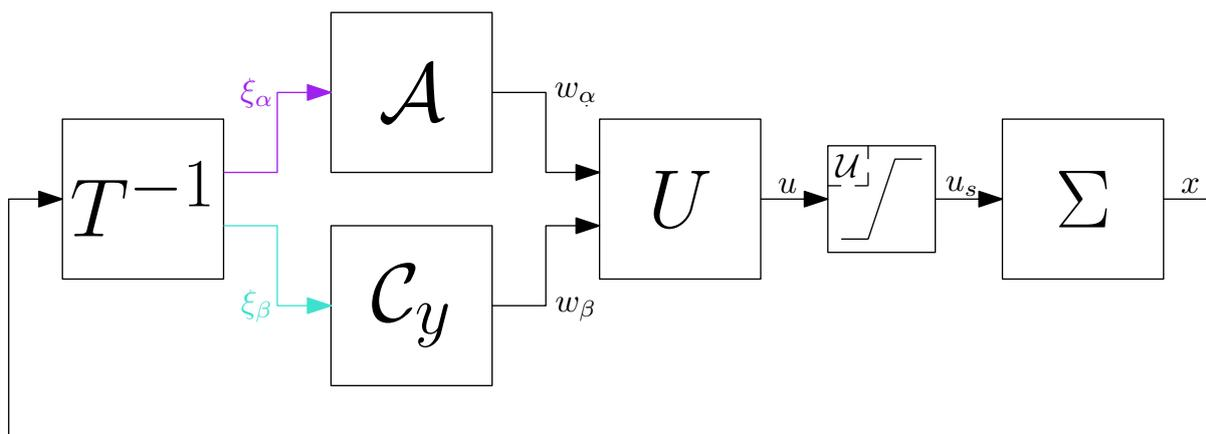
FIGURE 3.11 – Schéma de gestion naïve des contraintes d'entrée
