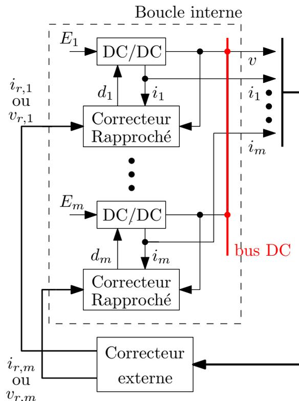
FIGURE 4.9 – Structure de commande en deux boucles imbriquées
