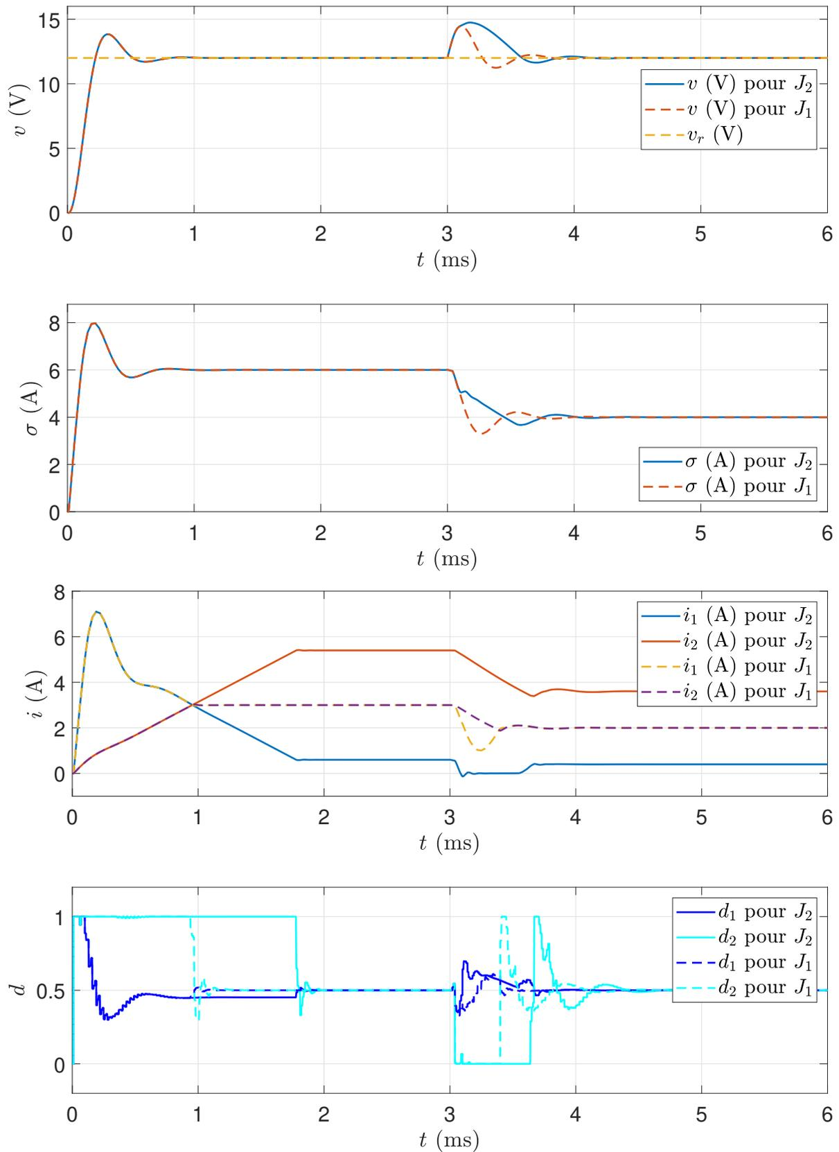
FIGURE 4.16 – Trajectoires d'état et d'entrée pour l'environnement de simulation pour l'approche quasi-statique
