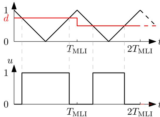
FIGURE 4.5 – Schéma de principe de la MLI
