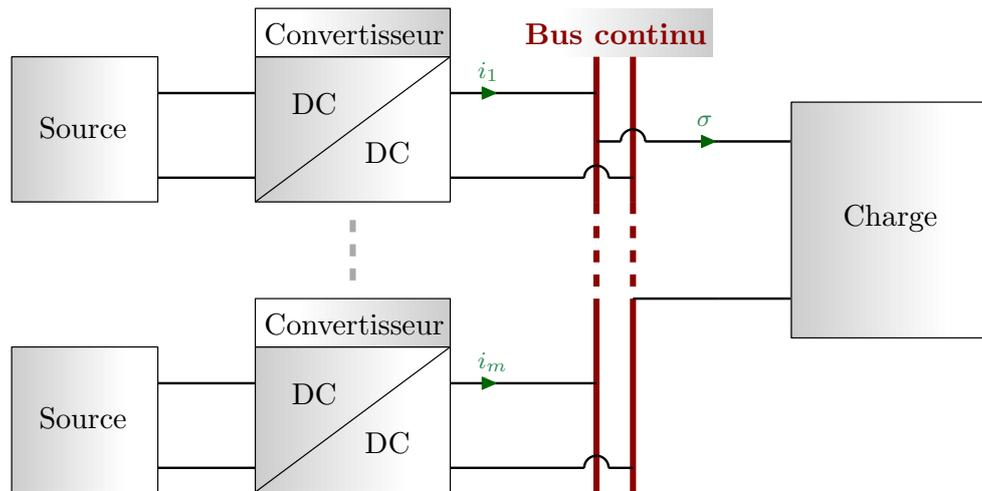
FIGURE 1.1 – Schéma de principe des convertisseurs en parallèle
