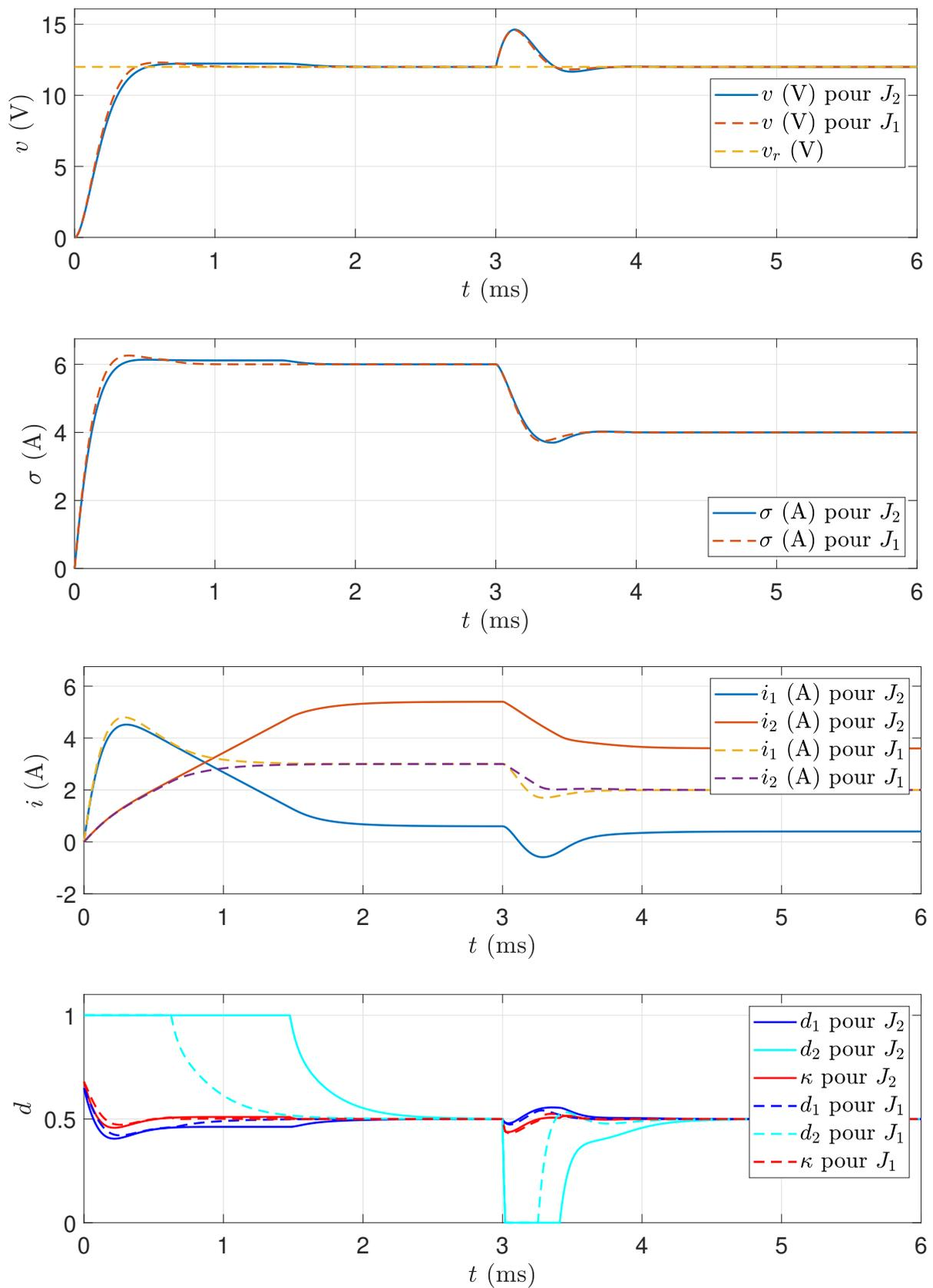
FIGURE 4.33 – Trajectoires d'état et d'entrée pour l'environnement de simulation avec la gestion naïve des contraintes
