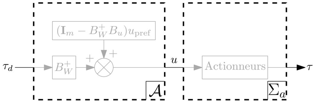
FIGURE 3.4 – Schéma de principe de l'approche par pseudo-inverse
