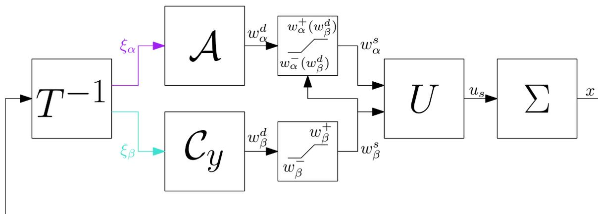
FIGURE 3.13 – Schéma de la gestion des contraintes d'entrée proposée
