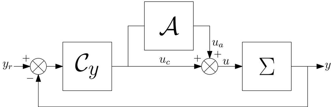
FIGURE 3.7 – Schéma de principe de l'allocation opératoire
