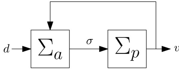
FIGURE 4.10 – Décomposition actionneur/procédé des convertisseurs Buck en parallèle
