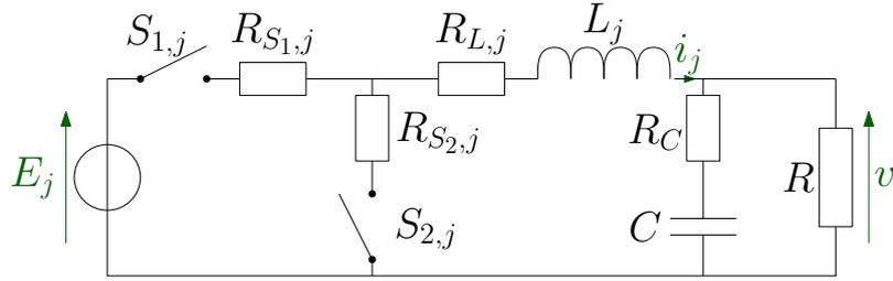
FIGURE 4.8 – Schéma d'un convertisseur Buck avec résistances parasites
