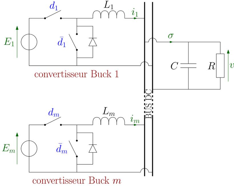
FIGURE 4.7 – Schéma de  $m$  convertisseurs Buck en parallèle
