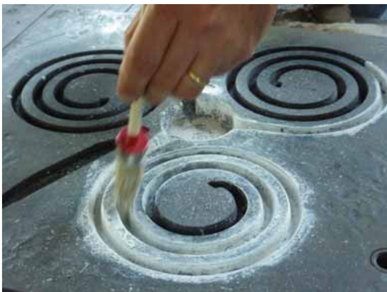
Figure 164: poteyage du moule métallique par du kaolin en suspension dans l'eau
