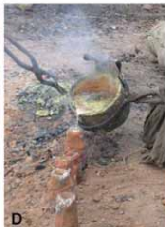
Figure 2 : fonte pleine par le procédé direct, village artisanal de Ouagadougou (Burkina Faso), mars 2008. A statuettes sculptées et modelées en cire ; B confection des moules de coulée ; C étuvage des moules autour d'un foyer ; D coulée du métal ; E statuettes en cours de finition.
