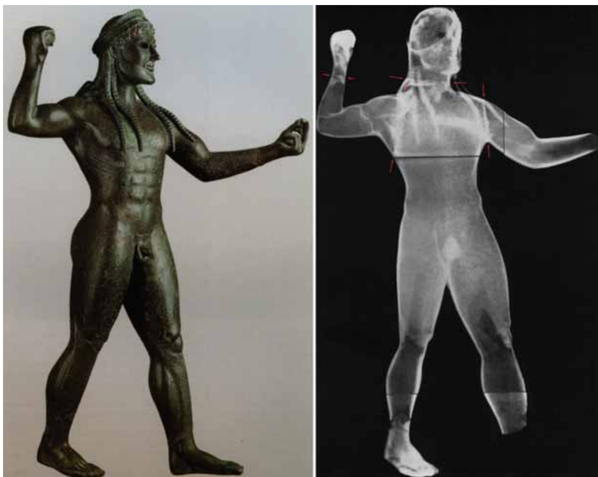
Figure 106 : statue de Zeus découverte à Ugento (Italie), h. 72 cm, -530 / -520 av. J.-C., musée archéologique national de Tarente, inv. 121.327 ; les flèches rouges sur la gammagraphie indiquent l'emplacement des soudures. La base antique n'est pas présentée.
