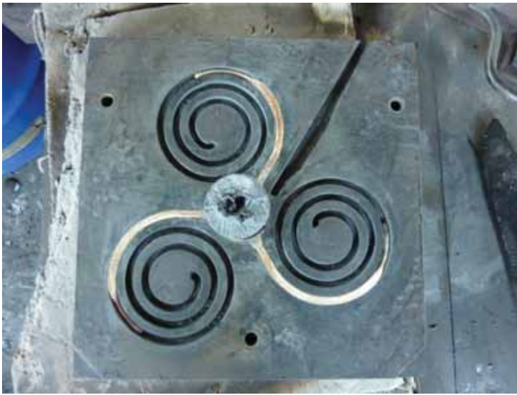
Figure 157 : résultat d'un essai de coulabilité, remarquer l'amincissement de l'extrémité des spirales.
