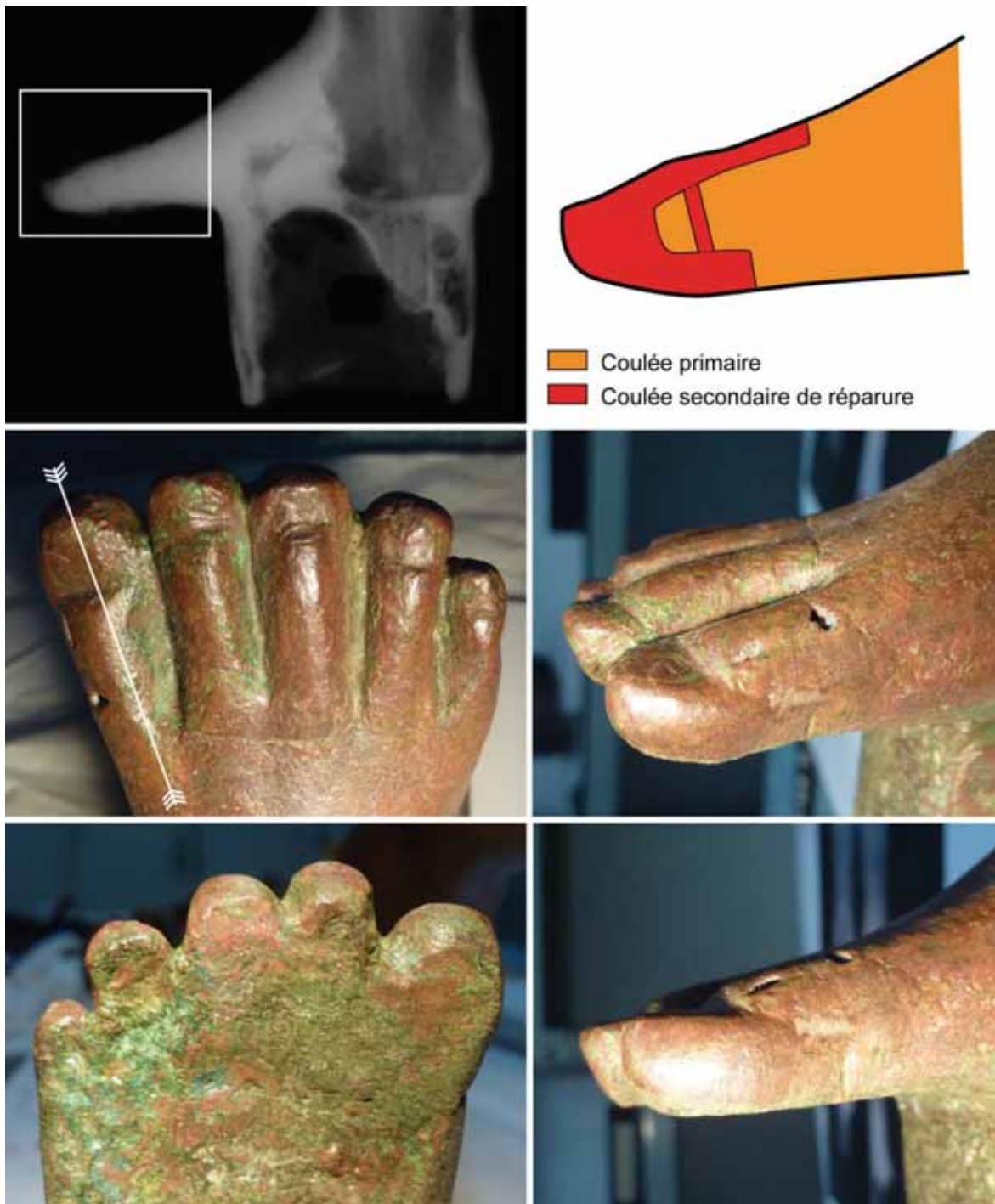
Figure 95 : détails photographiques et radiographique de la coulée secondaire de réparation des orteils du pied droit de la statue de prêtre (E7692). Une coupe longitudinale du gros orteil est présentée comme schéma d'interprétation. La coulée secondaire est visible aussi bien sur la radiographie qu'à la surface du pied. En revanche, le forage de la coulée primaire est une proposition d'explication du mode d'assemblage: l'intrication de la coulée secondaire dans la coulée primaire permettrait le maintien en position de la réparation ( interlock joining ).
