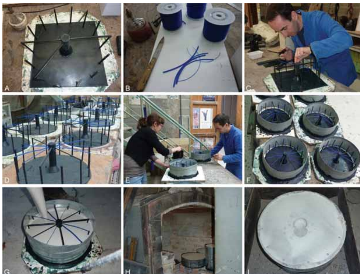
Figure 169 : Fabrication des modèles en cire et des moules à la fonderie de Coubertin. A : mise en place du système d'alimentation, des événements, et des tiges de 4 et 6 mm. B : préparation des fils de cire de 1, 2 et 3 mm. C : soudage des fils de cire. D : modèles de cire achevés. E : mise en place des cerclages métalliques. F : moules achevés. G : moulage au plâtre réfractaire. H : enfournement des moules. I : moules décirés et cuits.
