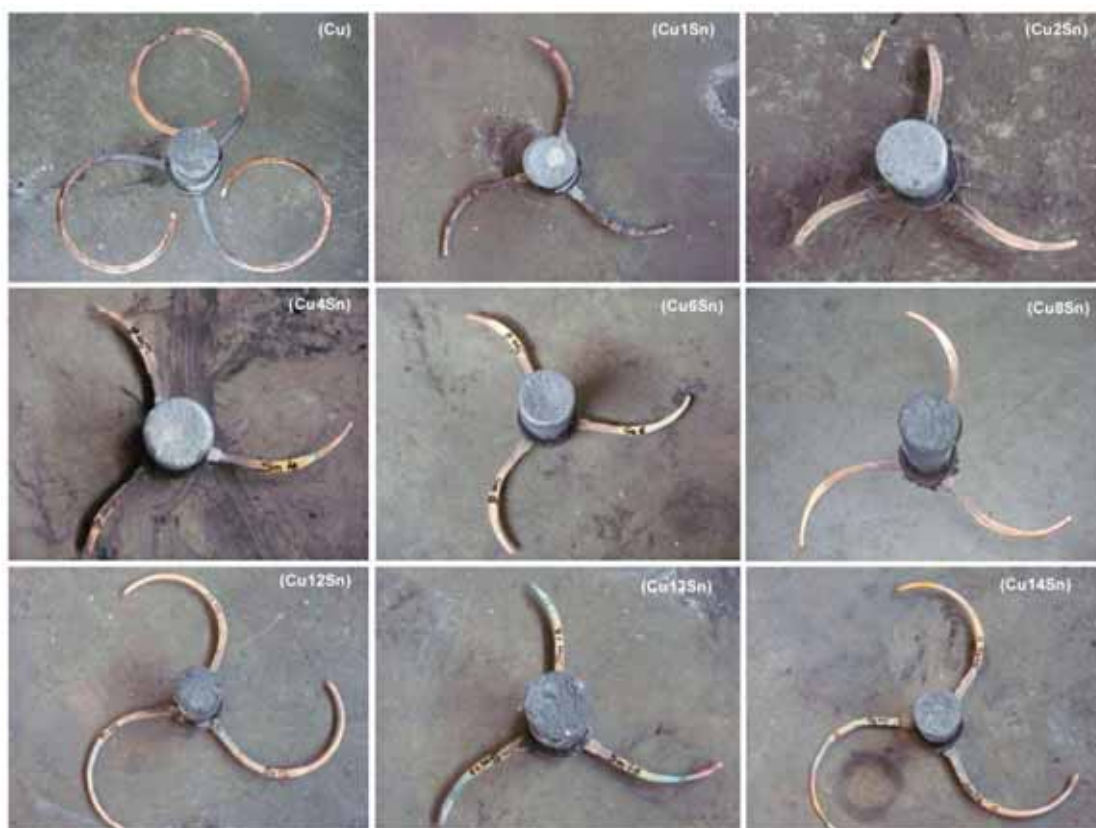
Figure 158 : exemples de spirales classées par teneur croissante en étain
