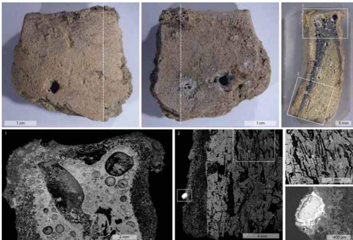
Figure 20 : fragment de creuset n° inv MR.79.2H.18.14, n° C2RMF FZ25404. En haut, de gauche à droite : face externe, face interne (noter la concrétion cuivreuse au bord du trait de coupe) et vue d'ensemble de la coupe transversale. En bas, de gauche à droite, détails de la coupe transversale, images MEB en électrons rétrodiffusés : bord supérieur (la texture bulleuse témoigne de la forte vitrification et du caractère peu réfractaire de la terre argileuse composant le creuset), partie basse
