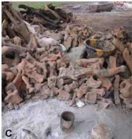
Figure 2 : fonte pleine par le procédé direct, village artisanal de Ouagadougou (Burkina Faso), mars 2008. A statuettes sculptées et modelées en cire ; B confection des moules de coulée ; C étuvage des moules autour d'un foyer ; D coulée du métal ; E statuettes en cours de finition.
