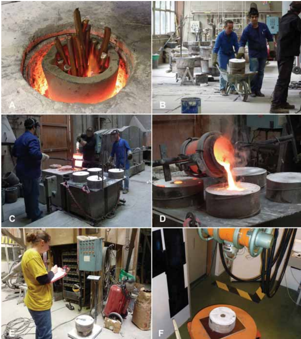
Figure 170 : A : fonte des barres de cuivre dans le four à induction. B : transport de 3 moules préchauffés à 350^{\circ}\text{C} vers le poste de coulée. C : contrôle de température du métal avant coulée. D : deuxième étape d'une séquence de quatre coulées (métal surchauffé à +200^{\circ}\text{C} et moule préchauffé à 600^{\circ}\text{C} ). E : pesée du moule après coulée (mesure de la masse de métal effectivement versée). F : à l'issue des coulées, tous les moules ont été radiographiés au C2RMF.
