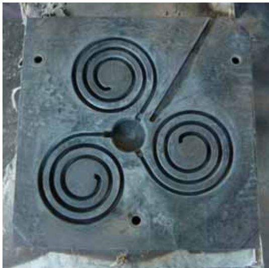
Figure 155 : en haut : dessin technique du moule permanent en acier C45. Chaque spirale mesure 95 cm de longueur, les canaux sont de section trapézoïdale pour faciliter le démoulage, la superficie de cette section vaut 0,75 \text{ cm}^2 . Le métal est coulé par le puits central d'alimentation, des évents placés aux extrémités des spirales permettent de chasser l'air et les gaz pendant la coulée. En bas à gauche : détail du moule. En bas à droite : préchauffage du moule muni de son couvercle à 320^\circ \text{ C} au moyen d'un chalumeau.
