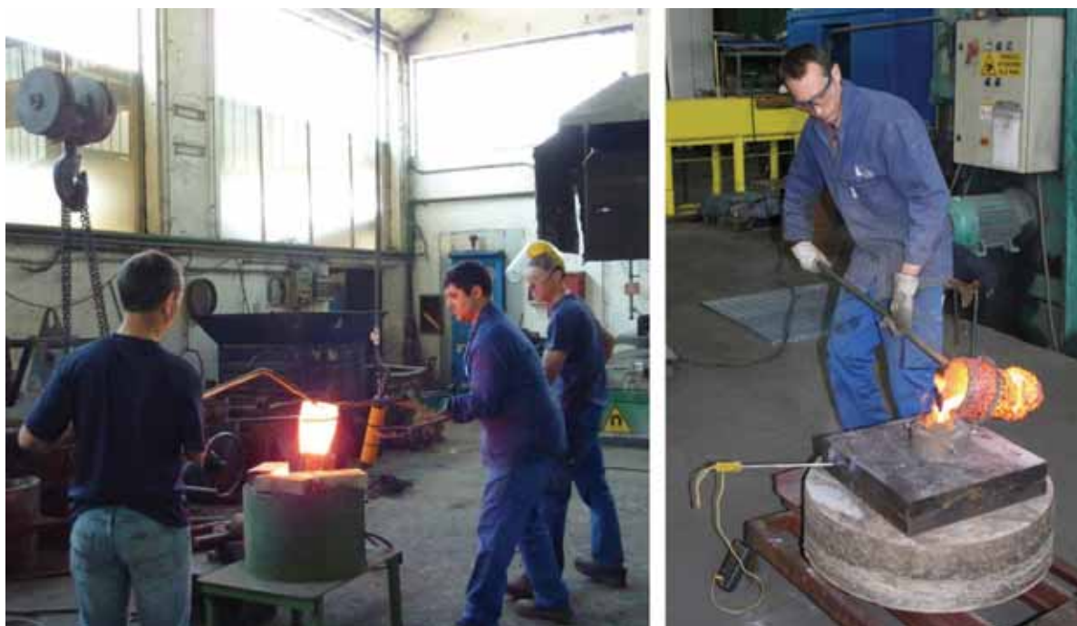
Figure 156 : à gauche, prise de température de l'alliage dans le creuset en sortie de four ; à droite, coulée par A. Adobati.
