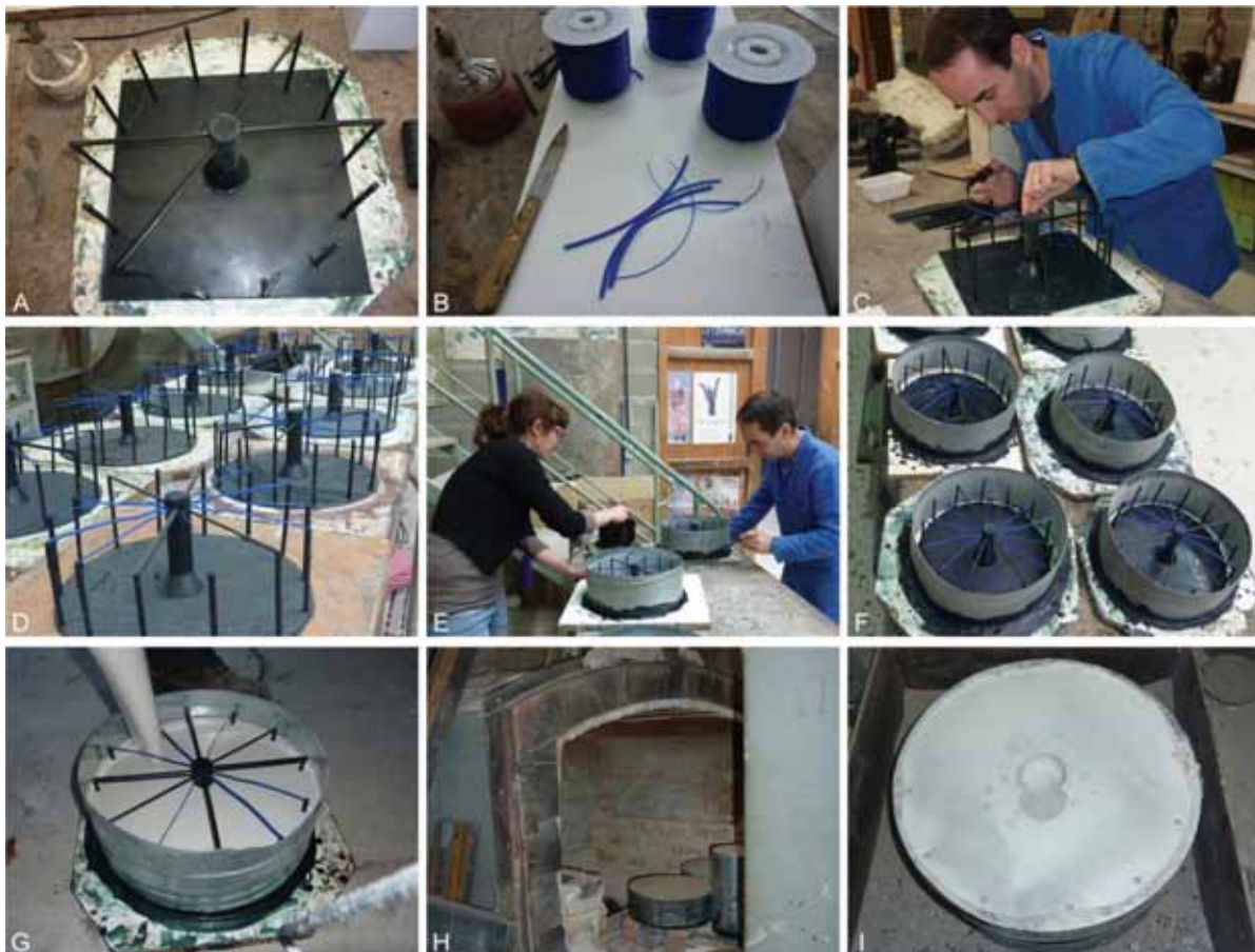
Figure 169 : Fabrication des modèles en cire et des moules à la fonderie de Coubertin. A : mise en place du système d'alimentation, des événements, et des tiges de 4 et 6 mm. B : préparation des fils de cire de 1, 2 et 3 mm. C : soudage des fils de cire. D : modèles de cire achevés. E : mise en place des cerclages métalliques. F : moules achevés. G : moulage au plâtre réfractaire. H : enfournement des moules. I : moules décirés et cuits.
