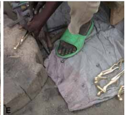
Figure 2 : fonte pleine par le procédé direct, village artisanal de Ouagadougou (Burkina Faso), mars 2008. A statuettes sculptées et modelées en cire ; B confection des moules de coulée ; C étuvage des moules autour d'un foyer ; D coulée du métal ; E statuettes en cours de finition.
