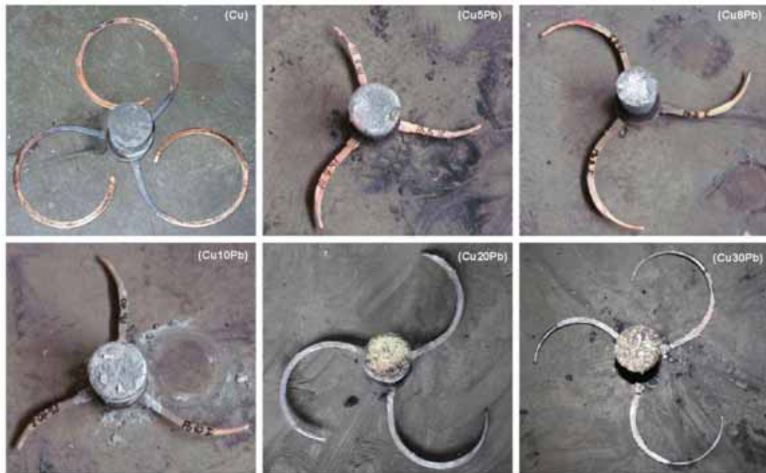
Figure 162 : exemples de spirales classées par teneur croissante en plomb
