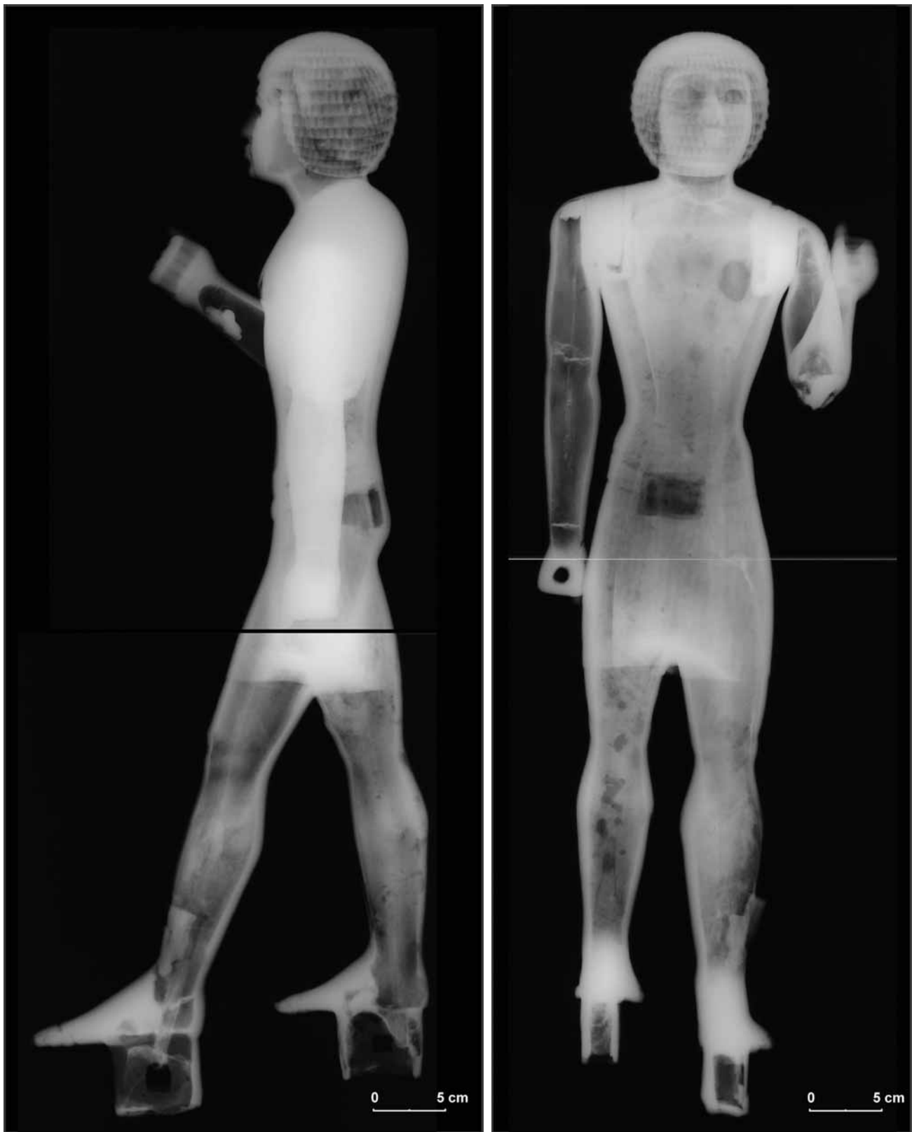
Figure 90 : radiographie X de face et de profil de la statue de prêtre (n° inv. E7692)
