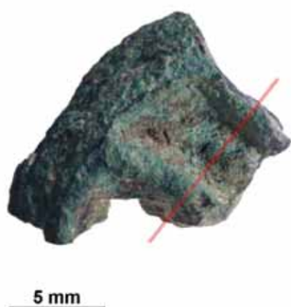
Figure 59 : a : fragment MR.81.2X.106.01 / FZ25410, possible fragment d'un sceau compartimenté, le trait rouge indique l'emplacement de la coupe ; b : vue d'ensemble de la coupe transversale de la tige au MEB-BSE après enrobage dans un plot de résine epoxy et polissage jusqu'au \frac{1}{4} \mu\text{m} .
