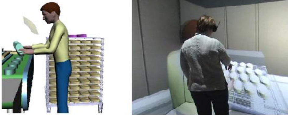
Figure 2-6. A gauche : simulation de l'usage à l'aide d'un mannequin numérique classique. A droite : visualisation immersive de la scène à l'aide de la réalité virtuelle. L'opérateur observe l'activité prédéfinie du mannequin numérique et reproduit les mouvements effectués par celui-ci (Mahdjoub 2007).
