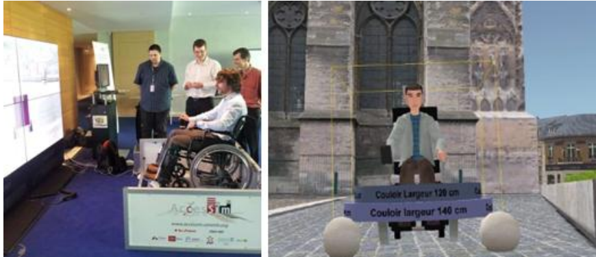
Figure 2-8. Utilisateur réel simulant un déplacement en fauteuil roulant dans l'environnement virtuel, et représentation d'un avatar virtuel.
