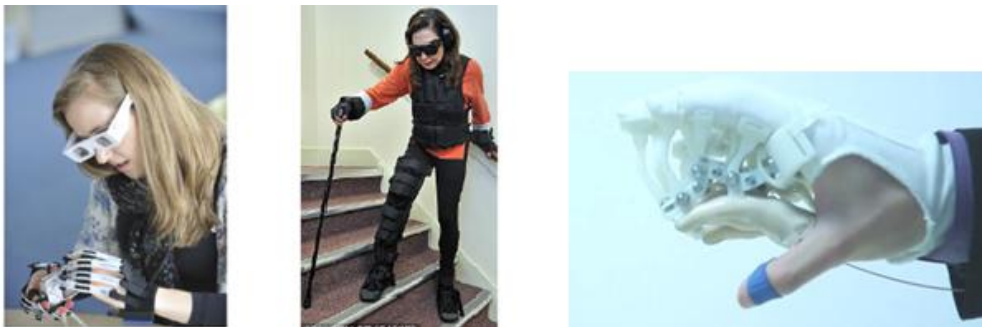
Figure 1-9. Gauche : gants et lunettes simulant une limitation de capacité (Cambridge (2013)). Centre : combinaison pour simuler les limitations de mouvements des personnes âgées (Mid Yorkshire Hospitals (2014)). Droite : Système de main passive permettant de simuler les capacités de préhension d'un jeune enfant (Projet "Childhood").
