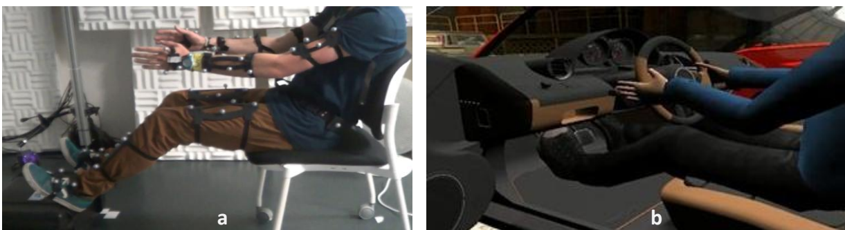
Figure 7-16. a) Position réelle de l'opérateur immergé simulant l'assise du conducteur dans l'EV. b) représentation virtuelle de la position du mannequin dans l'EV.
