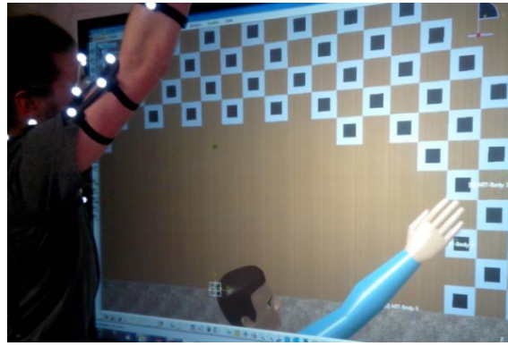
Figure 5-13. Concepteur en immersion contrôlant le mannequin virtuel en temps réel et évaluant l'atteinte de l'EV.
