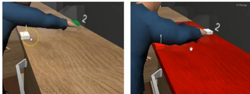
Figure 7-6. Visualisation de la tâche 2 par l'opérateur acteur. A gauche : mannequin 5 ème centile femme corpulence moyenne. A droite : mannequin 5 ème centile femme corpulence forte. Ici, le changement de corpulence ne permet plus au mannequin d'atteindre le point 2 (coloration blanche du point).
