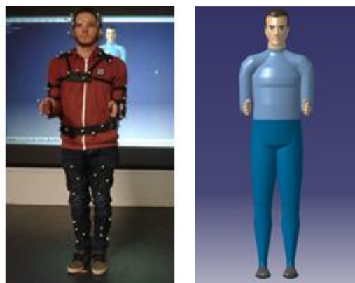
Figure 5-5. A gauche : le concepteur en immersion portant le dispositif de capture de mouvement optique. A droite : le mannequin numérique de DELMIAV5 affiché sur l'écran stéréoscopique situé devant le concepteur.
