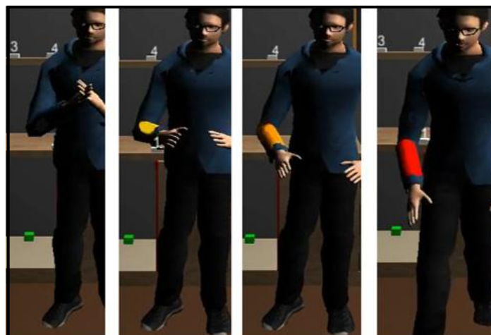
Figure 6-27. Exemple de limites fonctionnelles visualisées "quantitativement" sur le mannequin virtuel.
