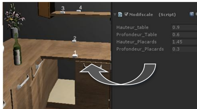
Figure 7-11. Interface permettant au concepteur de modifier en temps réel les variables dimensionnelles clés de l'environnement étudié.
