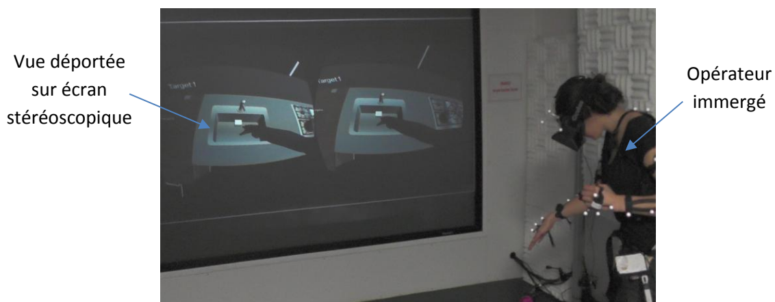
Figure 7-4. Opérateur immergé réalisant une évaluation d'atteinte dans l'EV, et écran stéréoscopique qui retranscrit la vision de l'utilisateur aux autres membres de l'équipe de conception.
