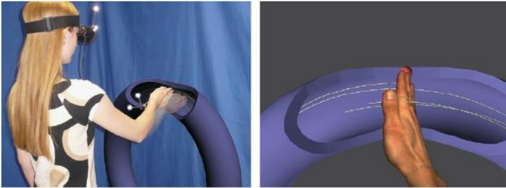
Figure 2-5. Simulation pseudo-haptique de la force d'un écoulement de fluide sur la main de l'utilisateur. Gauche : l'opérateur bouge la main pour compenser l'impact virtuel de l'écoulement du fluide. Droite : vision de la main virtuelle dans le visiocasque (Pusch et al. 2009).
