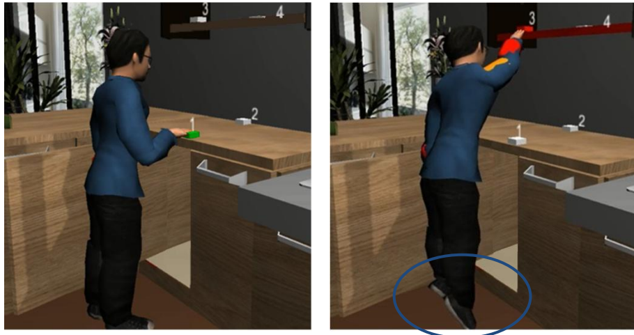
Figure 7-5. Comportements observés lors de l'évaluation immersive de l'activité du mannequin représentatif du 5 ème centile femme. A gauche : le mannequin réalisant la tâche 1. A droite : celui-ci se met sur la pointe des pieds pour atteindre un point situé au-dessus de sa tête (tâche 3).
