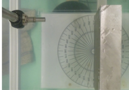
FIGURE 5.12 – Dispositif expérimental pour la mesure ultrasonore de plaques d'aluminium : la plaque est immergée dans de l'eau et insonifiée en réflexion.
