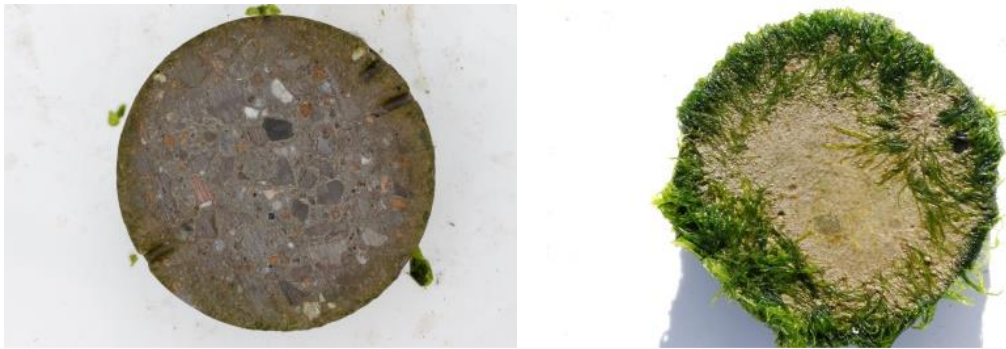
Figure 43: Colonisation d'éprouvette de béton en milieu marin (à gauche 21 jours d'immersion, à droite 42 jours).
