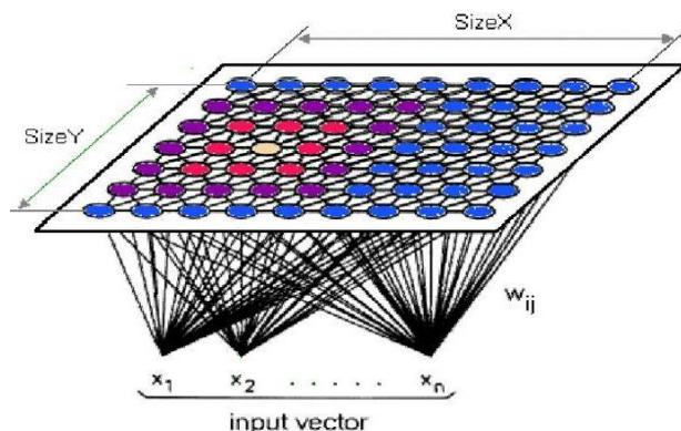
*Figure II.1 : Représentation de l'architecture typique d'une SOM.  $x_i$  représentent les composantes d'un vecteur d'entrée,  $w_{ij}$  connote le vecteur référent d'un neurone  $j$  qui a capté l'observation  $i$ .*
