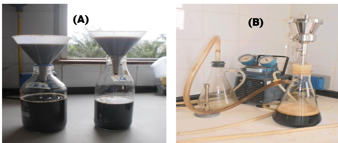
Figure 16: Solution d'extrait d' Eucalyptus microcorys : en (A), filtration avec du coton ; en (B) : filtration sous vide avec une membrane en nitrate de cellulose de porosité 0,45\mu\text{m} .
