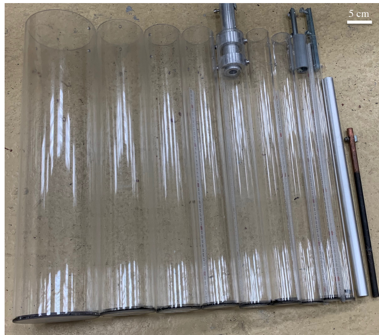
FIGURE 2.3 – Cylindres en polyméthacrylate de méthyle (PMMA) utilisés pour les expériences
