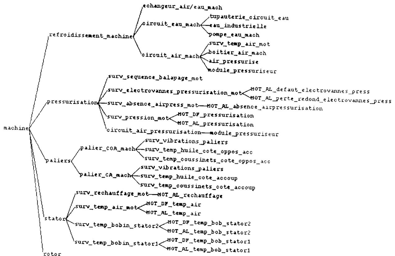
Figure II.16 Exemple de décomposition d'une machine
