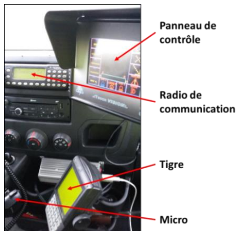
Photographie 4: Artefacts intégrés au niveau du poste de conduite du véhicule du site 3
