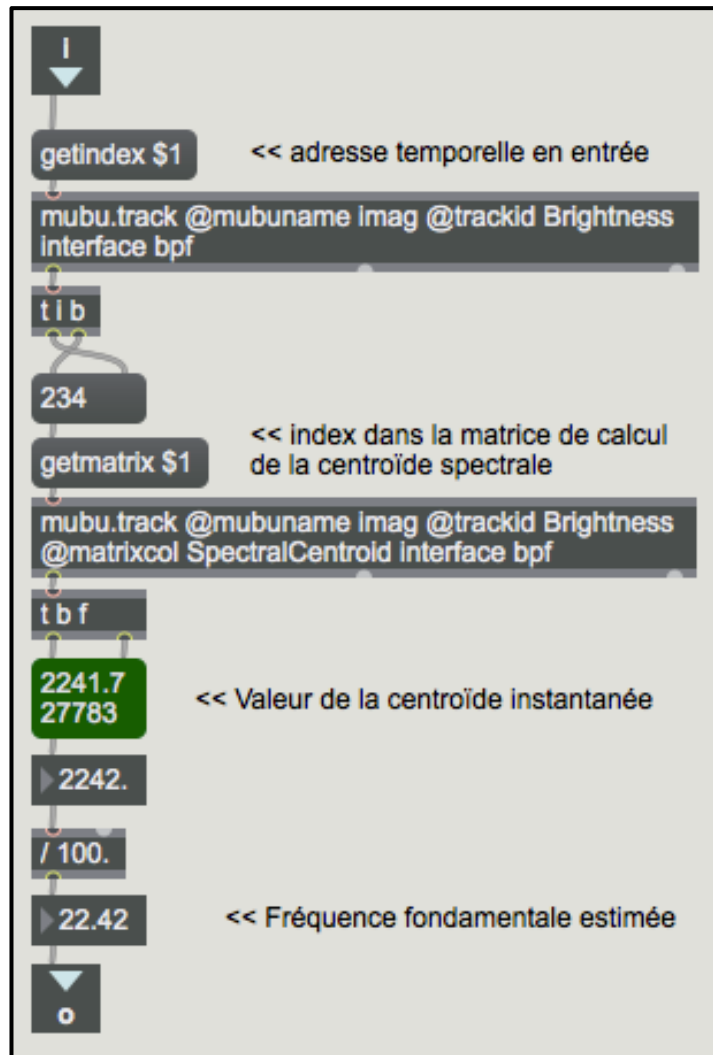
Figure IV.8.1 Sous-module d'évaluation de la centroïde spectrale instantanée
