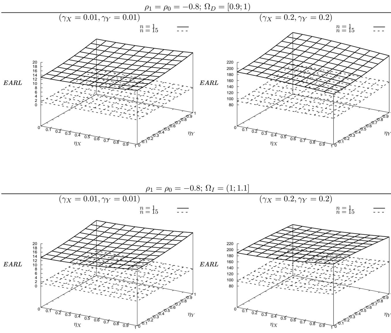
FIGURE 6.1 : Les effets de  $\eta_X$  et  $\eta_Y$  sur la performance globale de la carte Shewhart-RZ en présence d'erreurs de mesure pour  $z_0 = 1, ARL_0 = 200, \theta_X = \theta_Y = 0, \rho_M = 0, n \in \{1, 15\}, \gamma_X \in \{0.01, 0.2\}, \gamma_Y \in \{0.01, 0.2\}, \gamma_X = \gamma_Y$  et  $\rho_0 = \rho_1 = -0.8$
