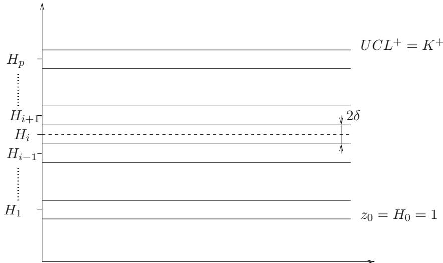
FIGURE 4.1 : Discrétisation de l’intervalle entre  $z_0 = 1$  et  $UCL^+ = K^+$  en  $p$  de sous-intervalles de largeur  $2\delta$  pour la cartes de contrôle EWMA-RZ<sup>+</sup>.
