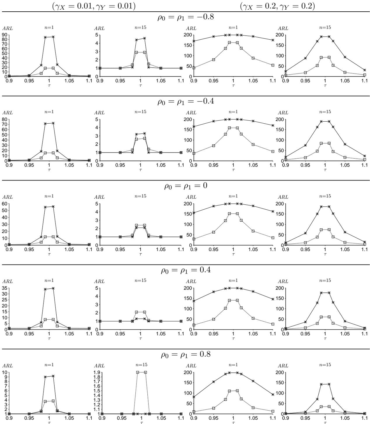
FIGURE 4.2 : Valeurs de  $ARL_1$  pour les cartes EWMA-RZ (-□-) et RZ (-\*) pour  $\gamma_X \in \{0.01, 0.2\}$ ,  $\gamma_Y \in \{0.01, 0.2\}$ ,  $\gamma_X = \gamma_Y$ ,  $\rho_0 \in \{-0.8, -0.4, 0, 0.4, 0.8\}$ ,  $\rho_0 = \rho_1$ ,  $\tau \in \{0.90, 0.95, 0.98, 0.99, 1.01, 1.02, 1.05, 1.10\}$ ,  $n \in \{1, 15\}$  et  $ARL_0 = 200$ .
