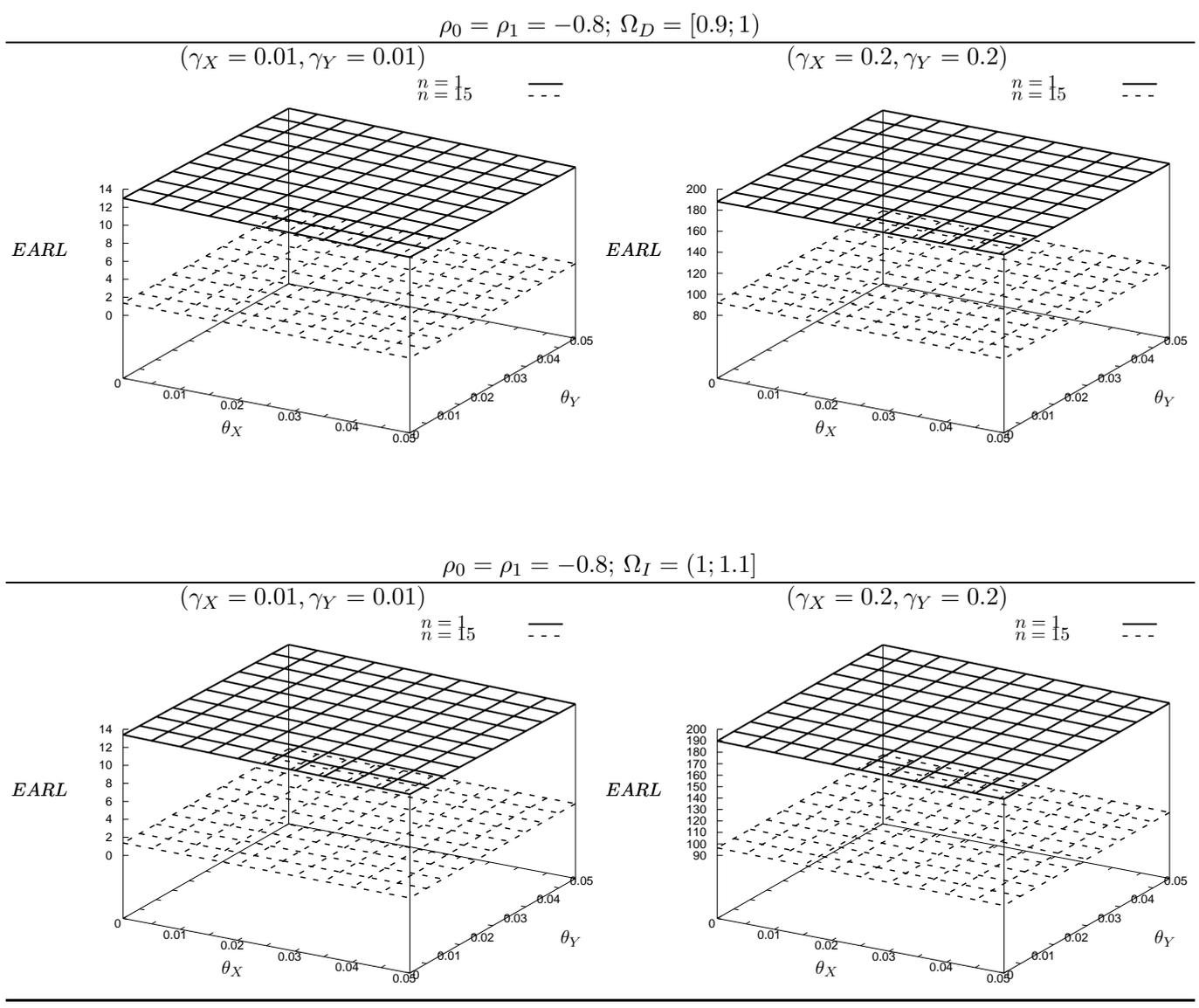
FIGURE 6.3 : Les effets de  $\theta_X$  et  $\theta_Y$  sur la performance globale de la carte Shewhart-RZ en présence d'erreurs de mesure pour  $z_0 = 1, ARL_0 = 200, \eta_X = \eta_Y = 0, \rho_M = 0, n \in \{1, 15\}, \gamma_X \in \{0.01, 0.2\}, \gamma_Y \in \{0.01, 0.2\}, \gamma_X = \gamma_Y$  et  $\rho_0 = \rho_1 = -0.8$
