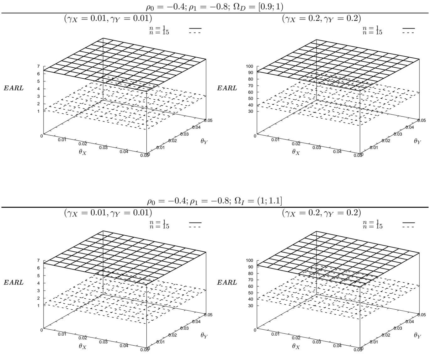
FIGURE 6.4 : Les effets de  $\theta_X$  et  $\theta_Y$  sur la performance globale de la carte Shewhart-RZ pour  $z_0 = 1$ ,  $ARL_0 = 200$ ,  $\eta_X = \eta_Y = 0$ ,  $\rho_M = 0$ ,  $n \in \{1, 15\}$ ,  $\gamma_X \in \{0.01, 0.2\}$ ,  $\gamma_Y \in \{0.01, 0.2\}$ ,  $\gamma_X = \gamma_Y$  et  $\rho_0 = -0.4, \rho_1 = -0.8$
