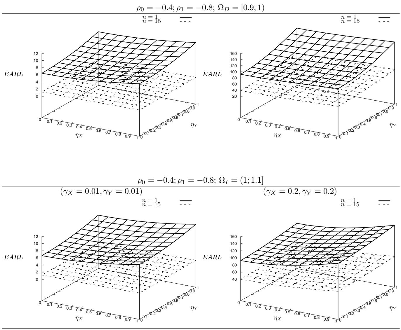
FIGURE 6.2 : Les effets de  $\eta_X$  et  $\eta_Y$  sur la performance globale de la carte Shewhart-RZ en présence d'erreurs de mesure pour  $z_0 = 1, ARL_0 = 200, \theta_X = \theta_Y = 0, \rho_M = 0, n \in \{1, 15\}, \gamma_X \in \{0.01, 0.2\}, \gamma_Y \in \{0.01, 0.2\}, \gamma_X = \gamma_Y$  et  $\rho_0 = -0.4, \rho_1 = -0.8$
