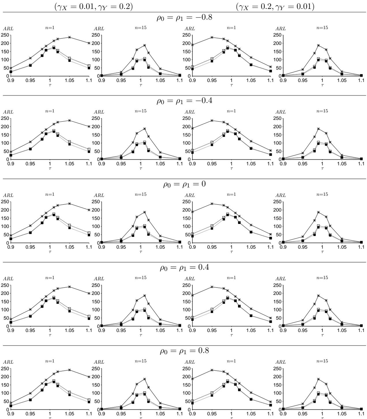
FIGURE 3.2 : Valeurs de  $ARL_1$  des cartes  $RRRZ_{2,3}$  ( $-\square-$ ),  $RRRZ_{3,4}$  ( $-\blacksquare-$ ) et Shewhart-RZ ( $-*-$ ) pour  $\gamma_X \in \{0.01, 0.2\}$ ,  $\gamma_Y \in \{0.01, 0.2\}$ ,  $\gamma_X \neq \gamma_Y$ ,  $\rho_0 \in \{0.8, -0.4, 0, 0.4, 0.8\}$ ,  $\rho_0 = \rho_1$ ,  $\tau \in \{0.90, 0.95, 0.98, 0.99, 1.01, 1.02, 1.05, 1.10\}$ ,  $n \in \{1, 15\}$  et  $ARL_0 = 200$
