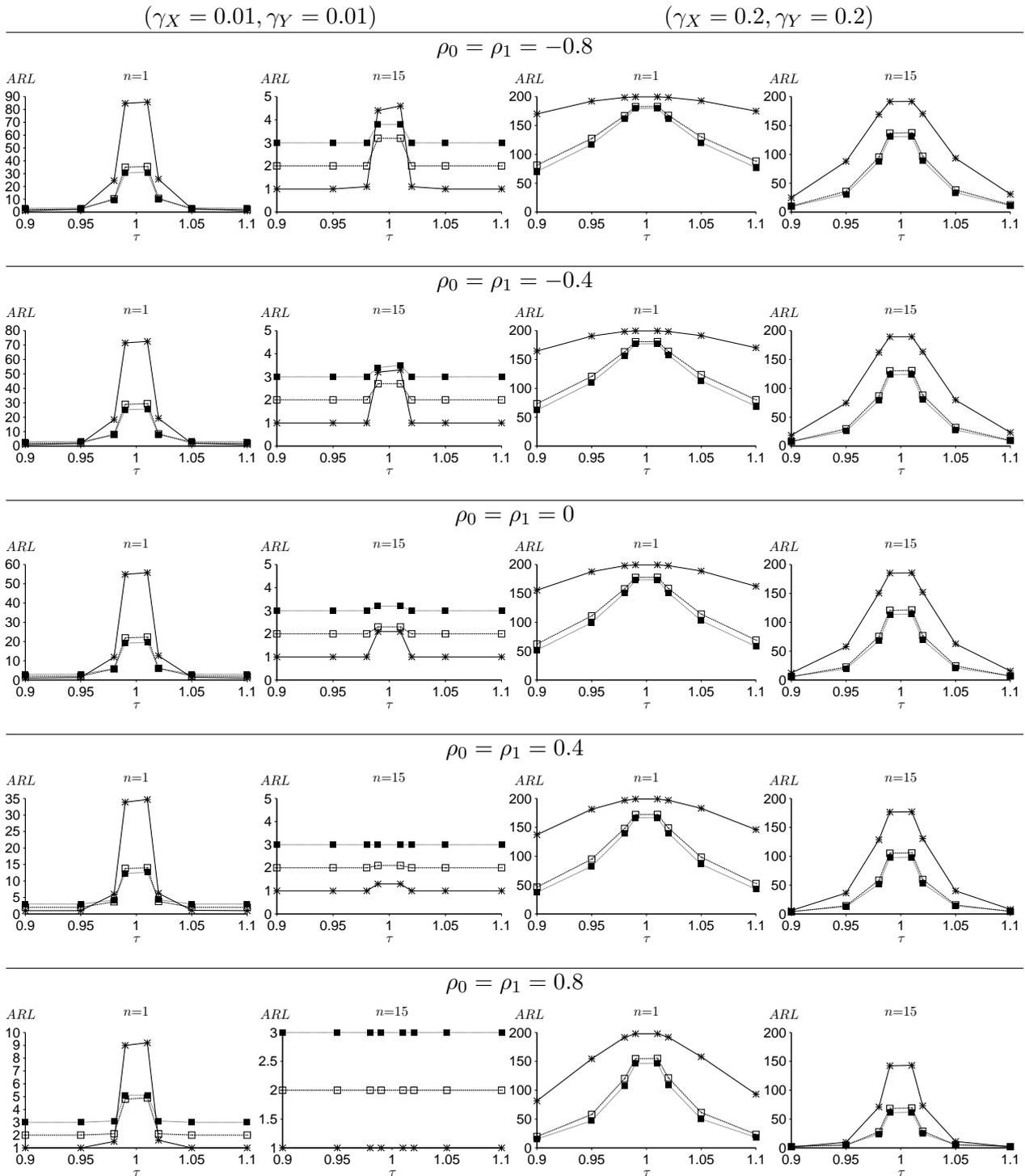
FIGURE 3.1 : Valeurs de  $ARL_1$  des cartes RRRZ<sub>2,3</sub> (-□-), RRRZ<sub>3,4</sub> (-■-) et Shewhart-RZ (-\*-) pour  $\gamma_X \in \{0.01, 0.2\}$ ,  $\gamma_Y \in \{0.01, 0.2\}$ ,  $\gamma_X = \gamma_Y$ ,  $\rho_0 \in \{-0.8, -0.4, 0, 0.4, 0.8\}$ ,  $\rho_0 = \rho_1$ ,  $\tau \in \{0.90, 0.95, 0.98, 0.99, 1.01, 1.02, 1.05, 1.10\}$ ,  $n \in \{1, 15\}$  et  $ARL_0 = 200$
