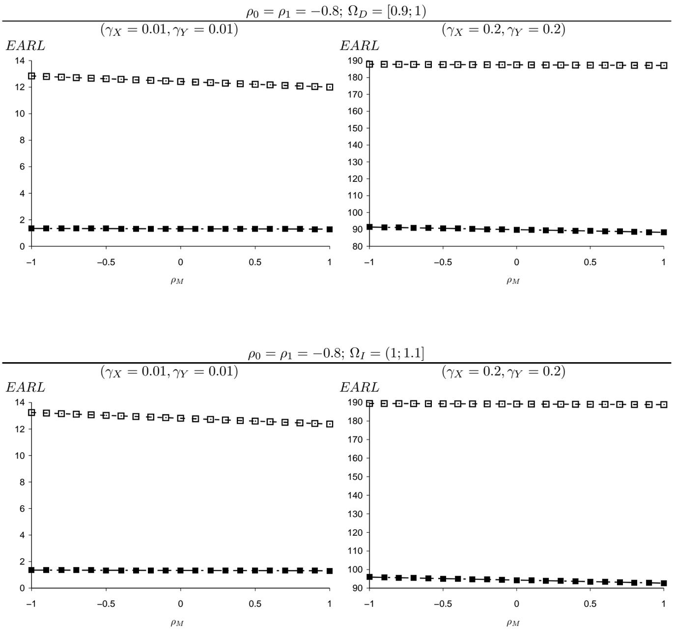
FIGURE 6.5 : L'effet de  $\rho_M$  sur la performance globale de la carte Shewhart-RZ en présence d'une erreur de mesure pour  $n = 1$  (□) et  $n = 15$  (■),  $z_0 = 1$ ,  $ARL_0 = 200$ ,  $\eta_X = \eta_Y = 0.28$ ,  $\theta_X = \theta_Y = 0.05$ ,  $n \in \{1, 15\}$ ,  $\gamma_X \in \{0.01, 0.2\}$ ,  $\gamma_Y \in \{0.01, 0.2\}$ ,  $\gamma_X = \gamma_Y$  et  $\rho_0 = \rho_1 = -0.8$
