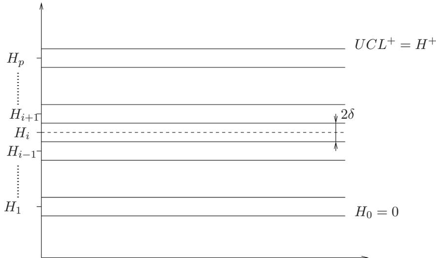
FIGURE 5.1 : Discretisation de l'intervalle entre 0 et  $UCL^+ = H^+$  en  $p$  de sous-intervalles de largeur  $2\delta$  pour la cartes de contrôle CUSUM-RZ<sup>+</sup>.
