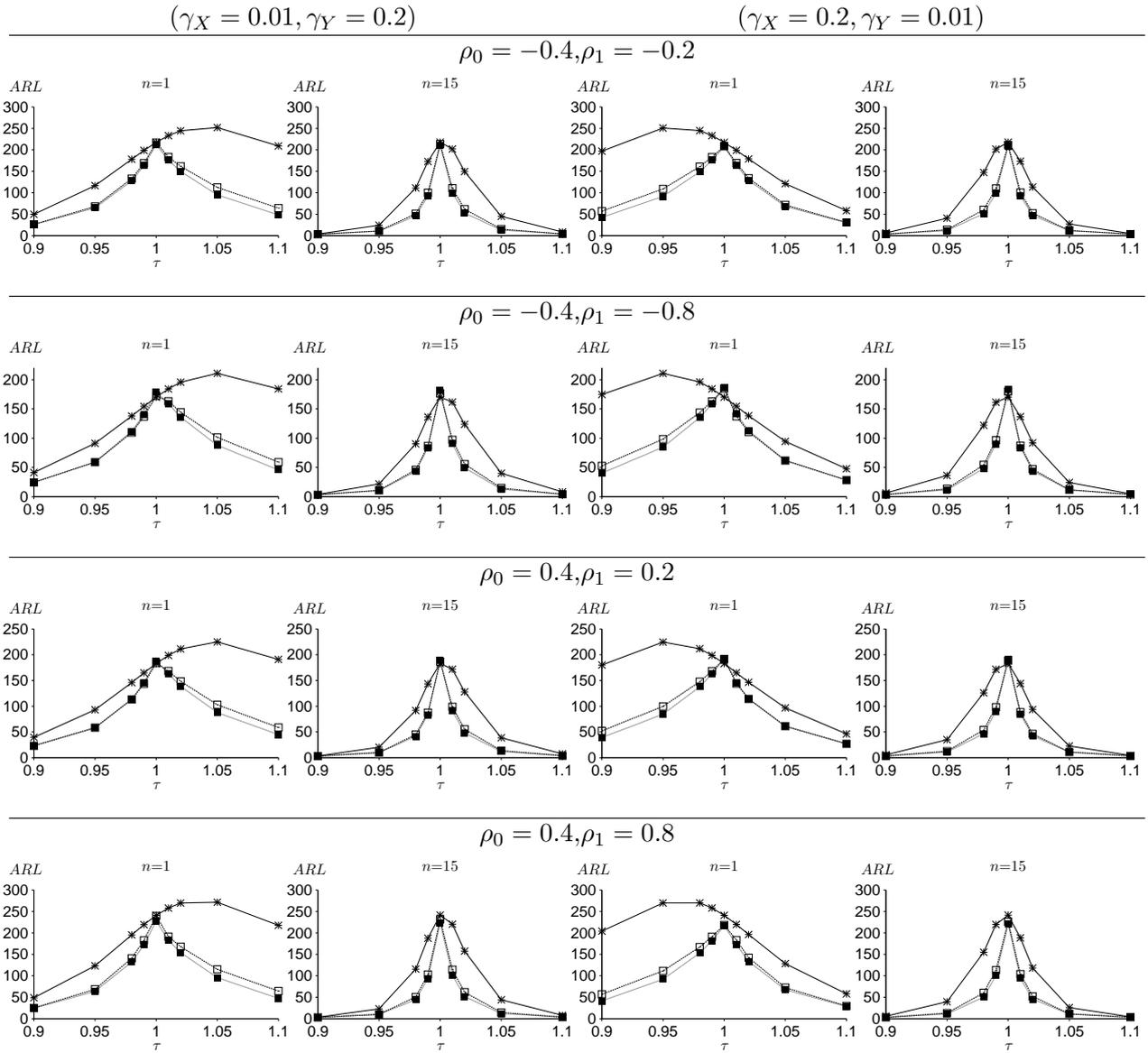
FIGURE 3.4 : Valeurs de  $ARL_1$  des cartes RRRZ<sub>2,3</sub> (-□-), RRRZ<sub>3,4</sub> (-■-) et Shewhart-RZ (-\*-) pour  $\gamma_X \in \{0.01, 0.2\}$ ,  $\gamma_Y \in \{0.01, 0.2\}$ ,  $\gamma_X \neq \gamma_Y$ ,  $(\rho_0, \rho_1) = \{(-0.4, -0.2), (-0.4, -0.8), (0.4, 0.2), (0.4, 0.8)\}$ ,  $\tau \in \{0.90, 0.95, 0.98, 0.99, 1.01, 1.02, 1.05, 1.10\}$ ,  $n \in \{1, 15\}$  et  $ARL_0 = 200$
