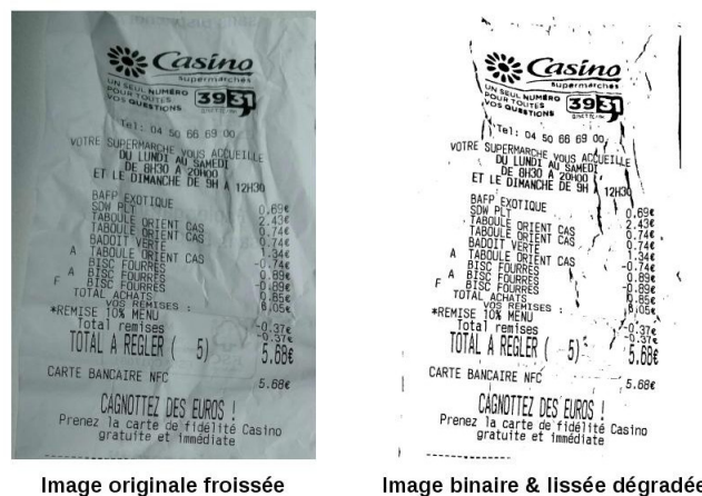
FIGURE 2.14. – Les limites de la binarisation lorsque le ticket est froissé.
