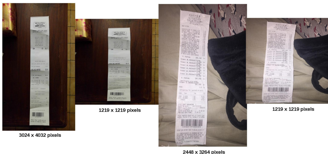
FIGURE 4.10. – Visualisation de la déformation légère du ticket dans l'image lorsque celle-ci est redimensionnée en une taille carrée de « 1219 x 1219 ».
