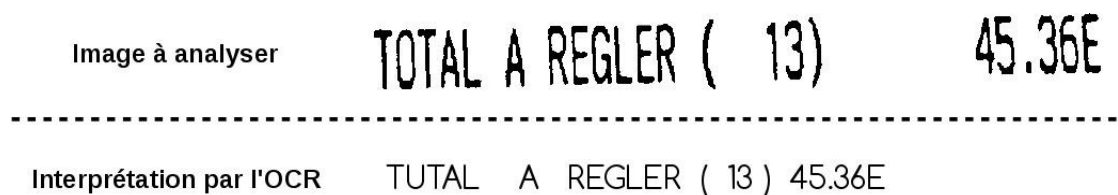
FIGURE 2.11. – Correction non faite par Tesseract car le niveau de confiance accordé au caractère erroné est trop élevé.
