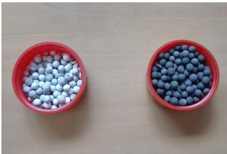
Figure 102 : Billes \text{Ag}/\text{TiO}_2/\text{AlPO}_4/\gamma\text{-Al}_2\text{O}_3 (à gauche) et Billes \text{Ag}/\text{ZnO}/\gamma\text{-Al}_2\text{O}_3 (à droite)
