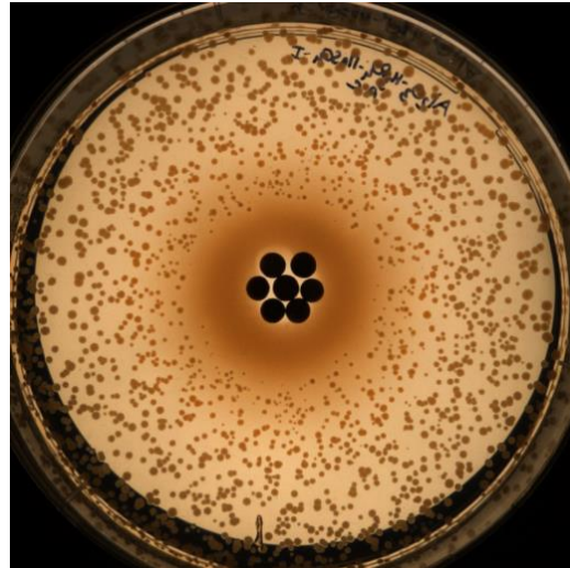
Figure 77 : Tests de zone d'inhibition sur milieu de culture TSA avec B. atrophaeus des billes \text{MnO}_2/\text{AlPO}_4/\gamma\text{-Al}_2\text{O}_3 après 43h d'incubation à 30,5 °C
