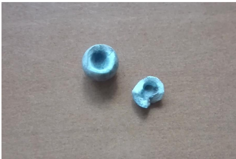
Figure 104 : Intérieur de billes \text{Ag/TiO}_2/\text{AlPO}_4/\gamma\text{-Al}_2\text{O}_3 s'étant fissurées au début du dépôt photochimique d'argent
