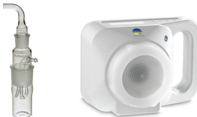
Figure 28 : BioSampler (à gauche) et impacteur d'air (à droite), deux techniques d'échantillonnage des bioaérosols
