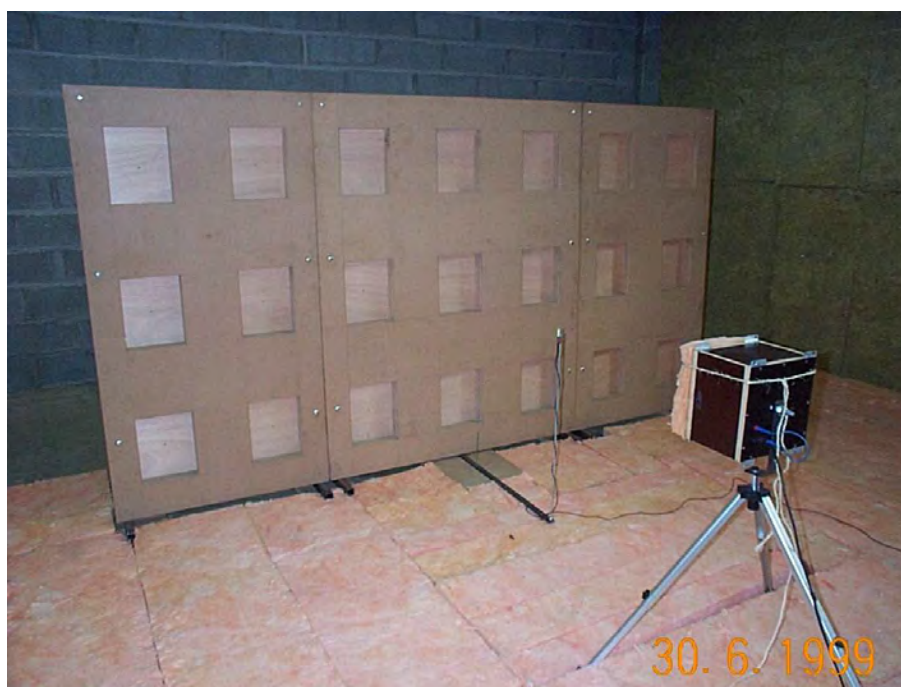
F . 3.47 — Photographie de la maquette au 1/5 d'une façade constituée d'un arrangement périodique de fenêtre. La maquette a été réalisée au LAUM dans le cadre du stage de M. E [67].
