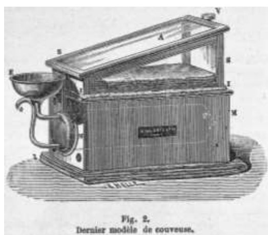
A. Couvercle mobile. V. Voie de sortie de l'air avec petite hélice. SS. Partie supérieure de la couveuse destinée à recevoir l'enfant. MM. Partie inférieure de la couveuse servant de chauffe-étuve. II. Interstice réunissant les deux étages, qui doit être comblé d'ouate. E. Entonnoir dans lequel on verse l'eau bouillante. O. Voie de sortie du liquide. LL. Couverture sur laquelle on place la couveuse.
