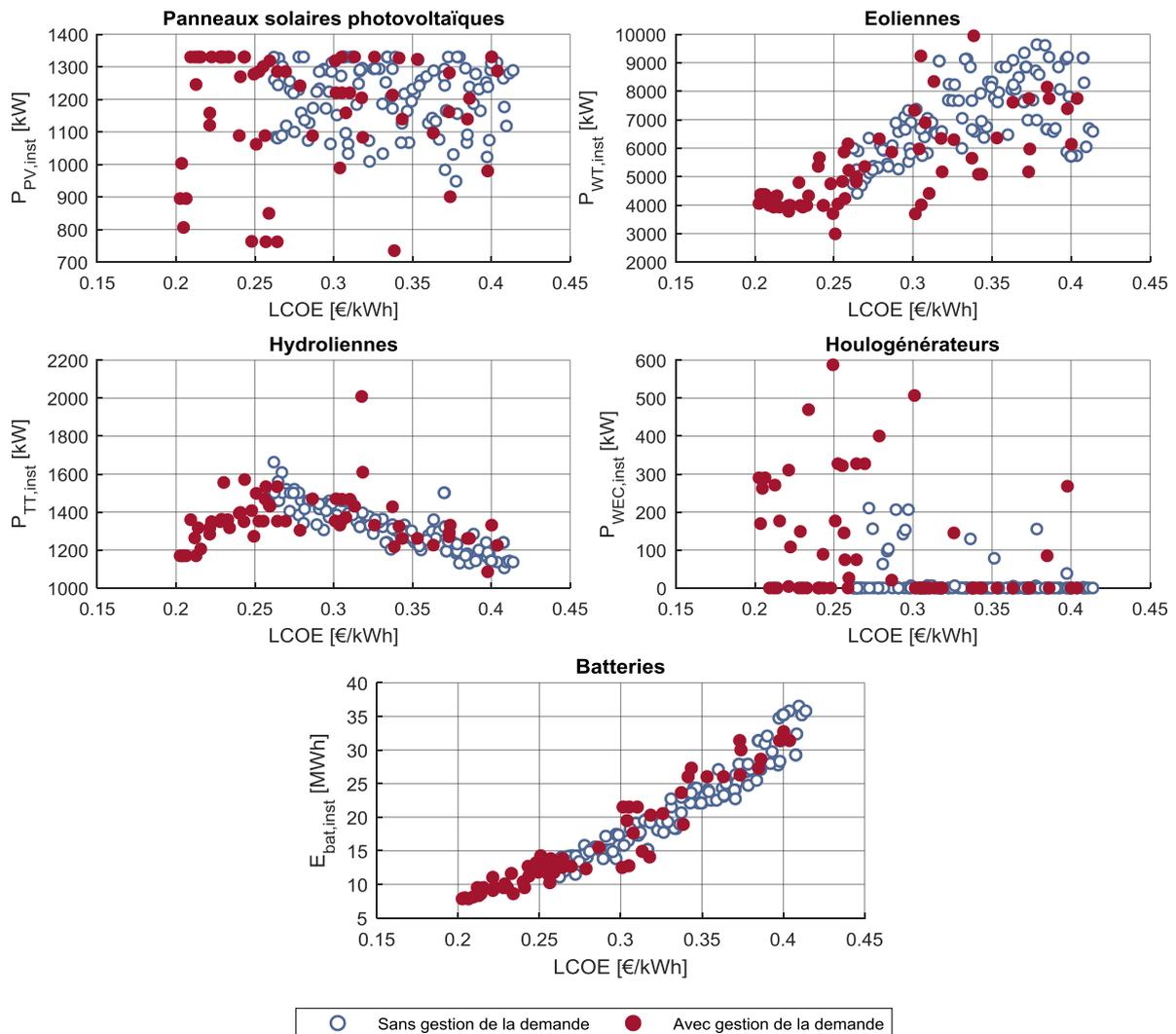
Figure IV-26 : Dimensionnement des solutions des fronts de Pareto obtenus sans et avec gestion de la demande, selon le coût actualisé de l'énergie
