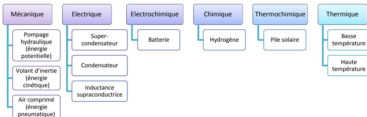
Figure I-13 : Classification des solutions de stockage, d'après [63], [64]
