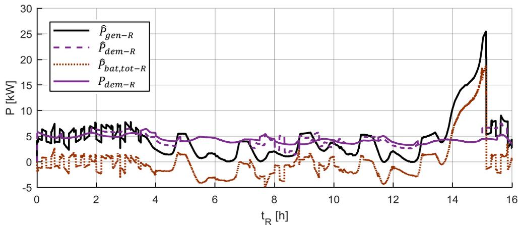
Figure V-22 : Mesures des puissances liées à la production totale des sources ( $\hat{P}_{gen-R}$ ), à la consommation totale ( $\hat{P}_{dem-R}$ ) et à la batterie ( $\hat{P}_{bat,tot-R}$ ) lors du test, et puissance initialement demandée ( $P_{dem-R}$ )
