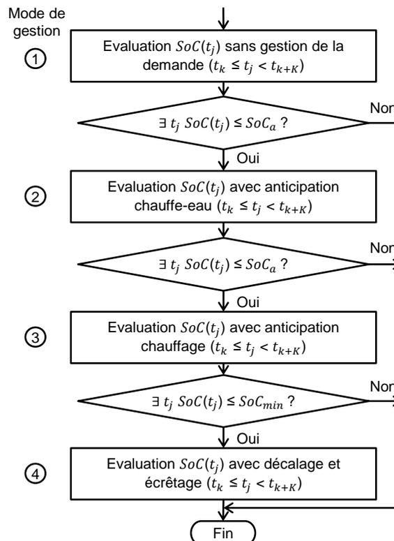
Figure IV-9 : Algorithme multi-niveaux de gestion de la demande
