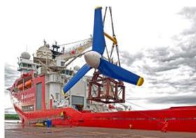
Figure I-6 : Hydrolienne à axe horizontal [40]
