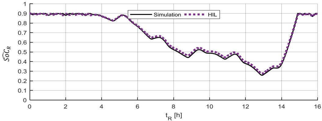
Figure V-16 : État de charge de la batterie obtenu par simulation puis par le test avec une batterie réelle
