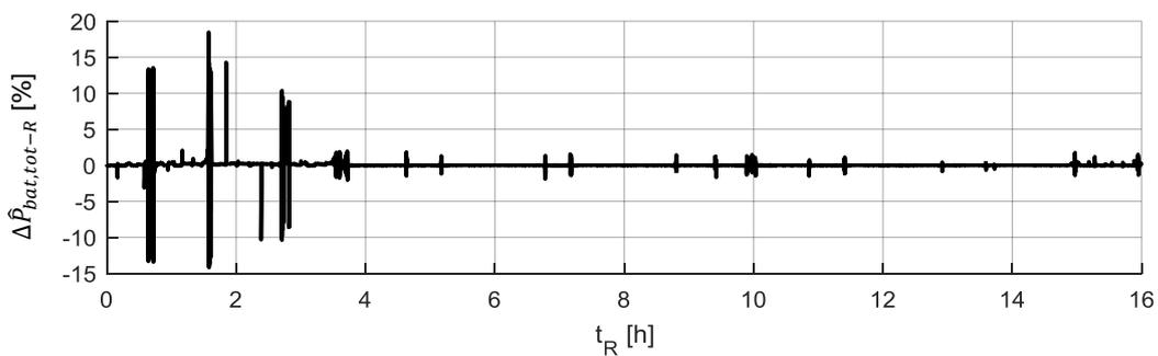
Figure V-19 : Écart relatif entre la puissance de la batterie obtenue lors du test et la puissance de la batterie obtenue par simulation
