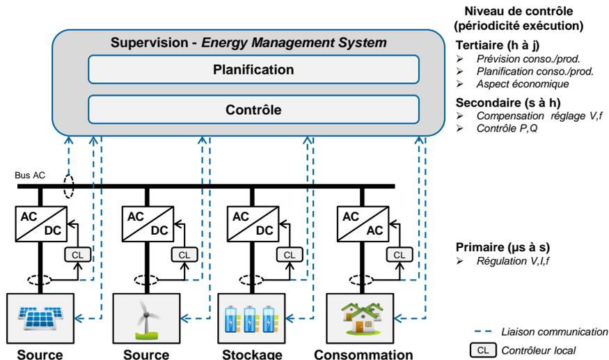
Figure I-15 : Vue globale du contrôle hiérarchique sur un micro-grid de type centralisé, à bus AC (inspirée des travaux [59], [68])
