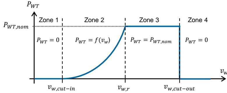
Figure II-6 : Courbe de puissance d'une éolienne
