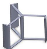
Figure I-7 : Hydrolienne à axe vertical, turbine Darrieus [36]
