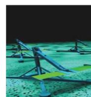
Figure I-9 : Hydrolienne à ailes battantes [39]
