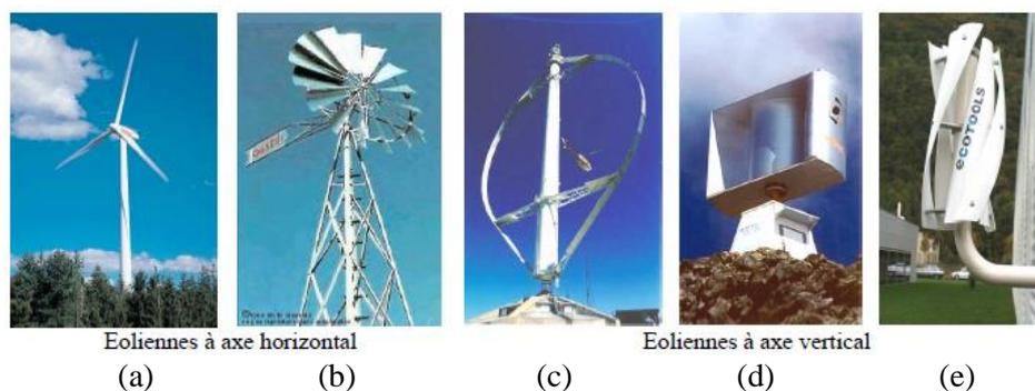
Figure I-3 : Technologies d'éoliennes [29]
