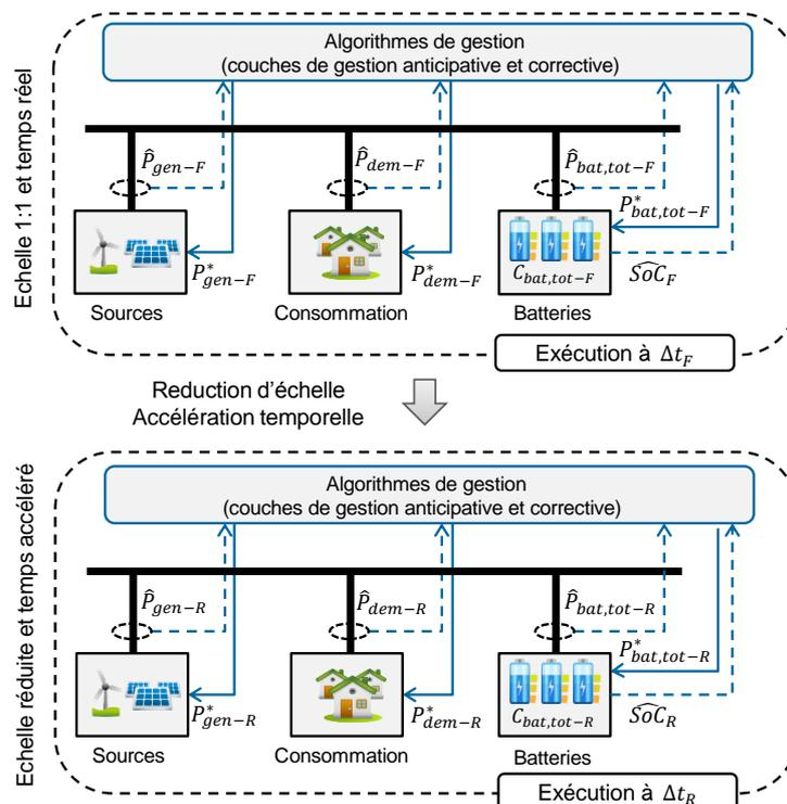
Figure V-10 : Modèles simplifiés du micro-réseau à pleine échelle et à échelle réduite
