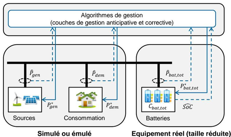
Figure V-9 : Architecture considérée pour la validation expérimentale
