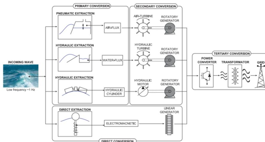
Figure I-10 : Étages de conversion d'un système houlomoteur [46]
