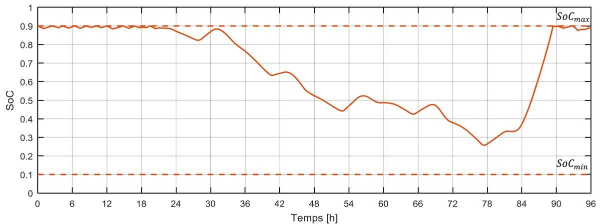
Figure V-6 : État de charge des batteries
