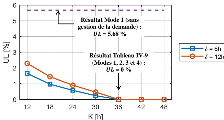
Figure IV-22 : Influence de la durée de planification  $K$  et du pas d'actualisation  $\delta$  sur le taux d'insatisfaction de la demande  $UL$
