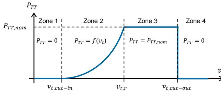
Figure II-9 : Courbe de puissance d'une hydrolienne
