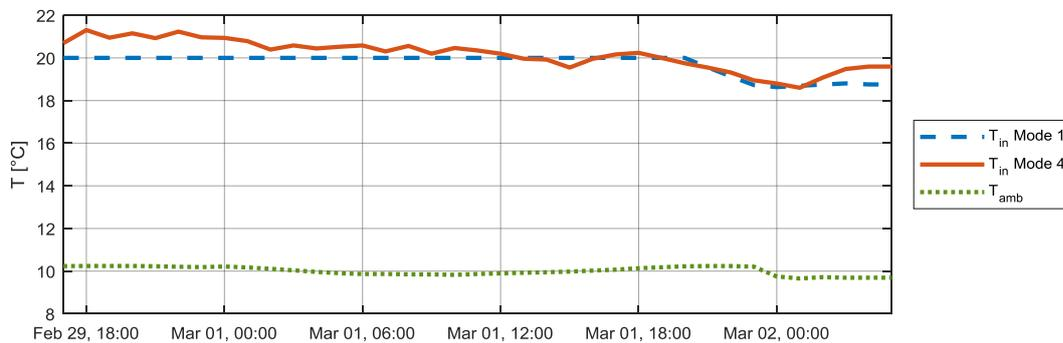
Figure IV-18 : Évolution de la température intérieure d'une habitation après évaluation du 4<sup>ème</sup> mode de gestion
