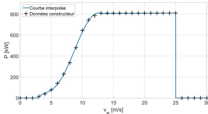
Figure II-7 : Courbe de puissance interpolée (éolienne Enercon E-53/800)
