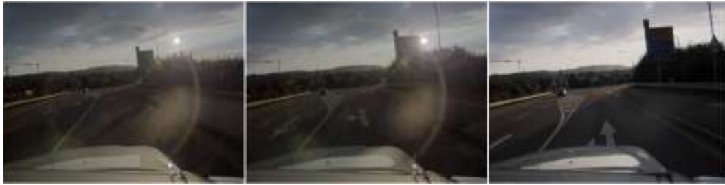
FIGURE 2.3 – Illustration de la compression de dynamique sur une séquence temporelle sur une scène HDR de conduite automobile. L’occultation du soleil en fin de séquence n’introduit pas de forte variation d’ambiance lumineuse sur le reste de l’image.
