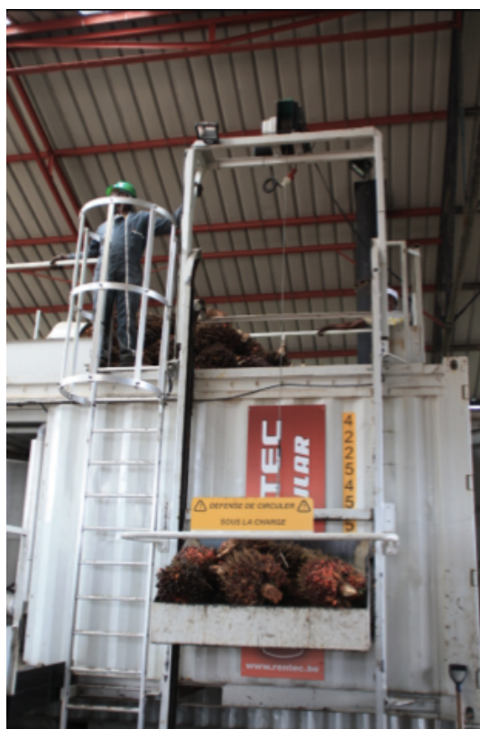
1- Chargement des régimes dans le modular avec l'élévateur
