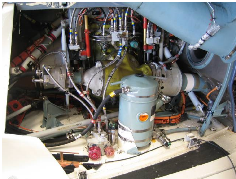
FIGURE 2.4: Boîte de transmission principale d'un hélicoptère
