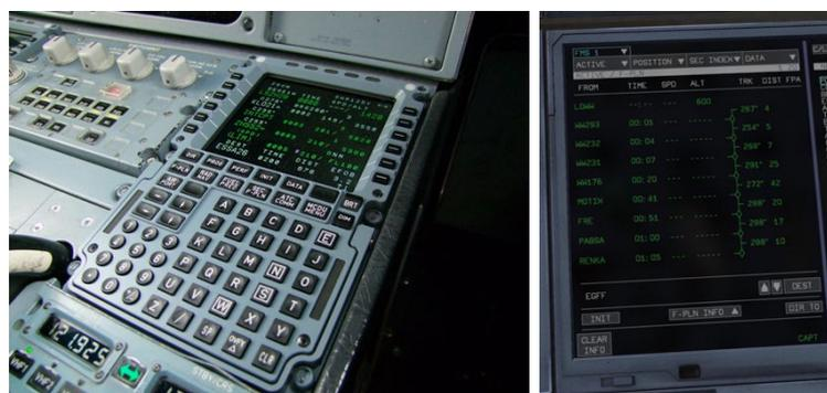
Figure 5. A gauche, *Multi Control Display Unit* (MCDU) sur l'Airbus A320. A droite, MCDU sur l'Airbus A350.
