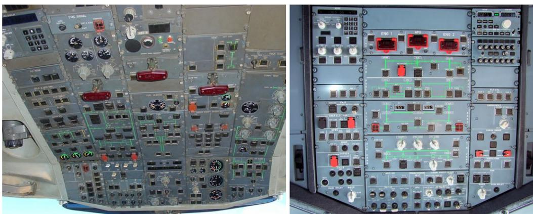
Figure 14. A gauche, le panneau en tête haute de l'A310 (1<sup>ère</sup> génération de glass cockpit). A droite, celui de l'A320 (2<sup>ème</sup> génération de glass cockpit).
