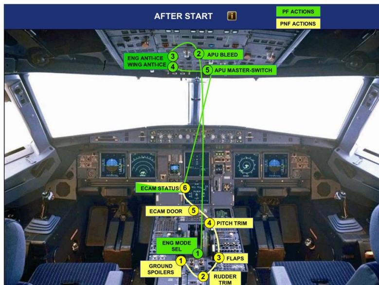
Figure 60. Illustration donnée dans un manuel d'apprentissage pour deux flots procéduraux à réaliser par les deux pilotes après avoir démarré les moteurs.
