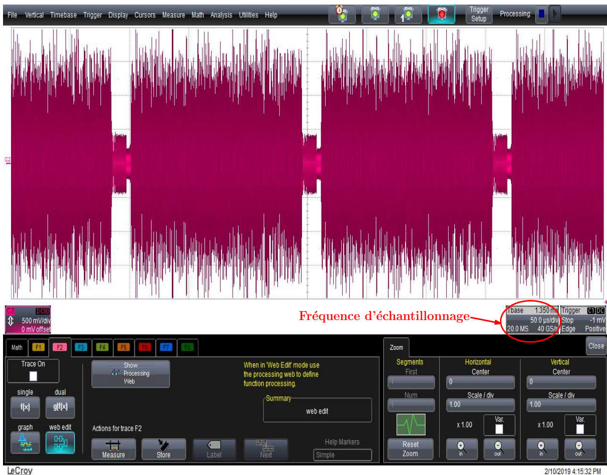
FIGURE 2.32 – Visualisation du signal RF sur l'oscilloscope
