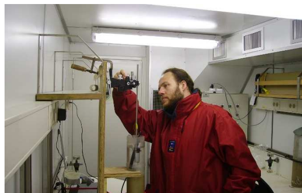
Figure 30 profilage de l'oxygène d'une carotte d'interface dans un container thermostaté du navire océanographique Pelagia (NIOZ, Pays-Bas).
