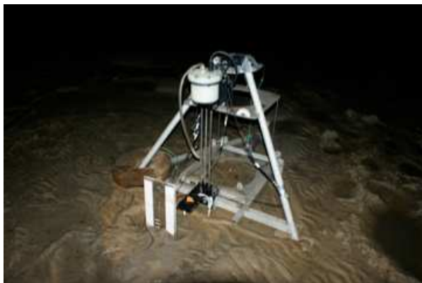
Figure 8 Dispositif déployé à Cassy, Bassin d'Arcachon pour le profilage et la mesure en temporelle d'espèces redox labiles en voltammétrie avec une électrode Hg/Au ((crédit photo : Bruno Deflandre).
