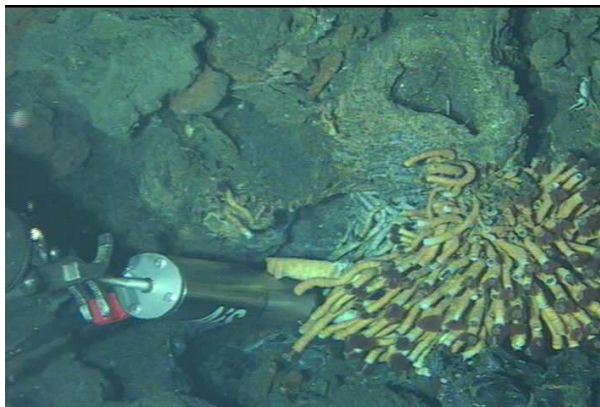
Figure 4 Sonde voltammétrique Analytical Instruments à la base d'une colonie de Tevnia sp. dans une zone d'efflux hydrothermaux au site EPR 9°50'N prise en janvier 2007. crédit photo : Woods Hole Institute.
