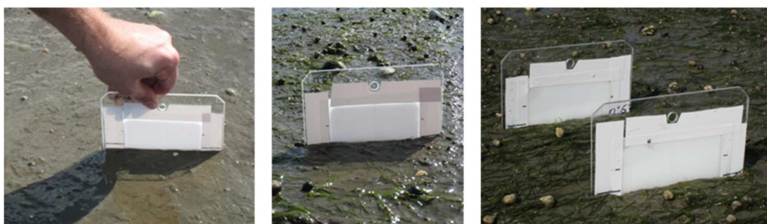
Figure 69 photos des sondes déployées en juin 2012 dans la station de Germanan dans des sites de densités de zostères variables. Le déploiement se fait à marée basse et la récupération à marée haute 4 à 6 heures plus tard.
