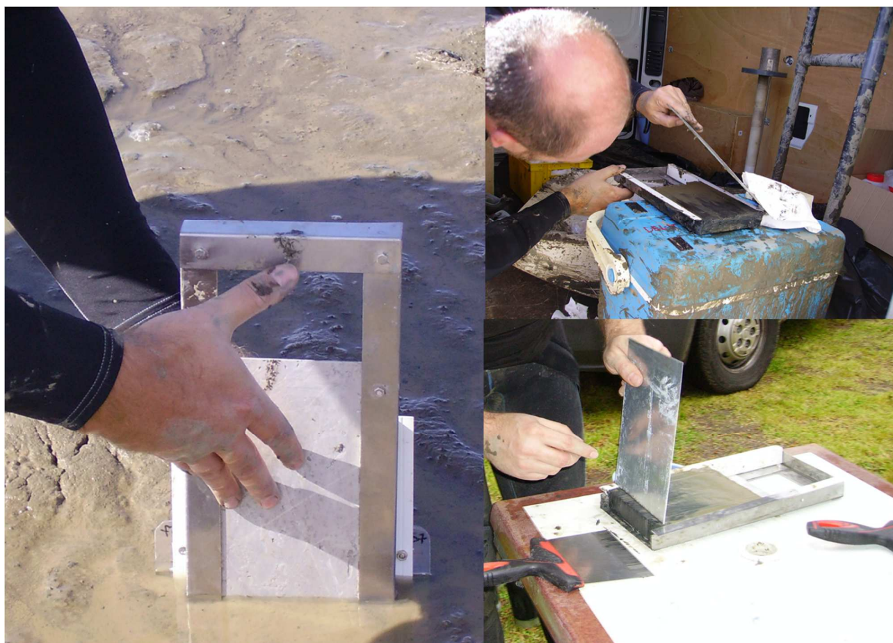
Figure 57 à gauche : insertion de la deuxième « mâchoire » dans le sédiment le long des guides présents sur le support de gel (première « mâchoire ») ; à droite : séparation des deux mâchoires (haut) et échantillonnage du sédiment (bas) réalisés en mai 2013 dans la vase des Brillantes (Estuaire de la Loire).
