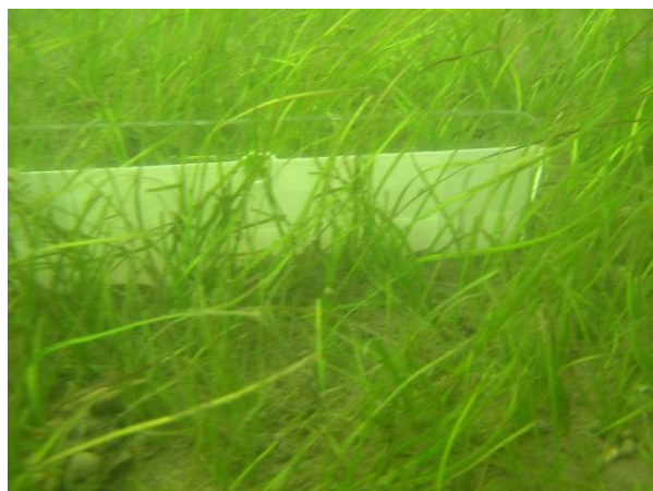
Figure 70 sonde DET-2D vue à marée haute (crédit photo D. Jézéquel). La récupération des plaques se fait en apnée, à l'étable de haute mer.
