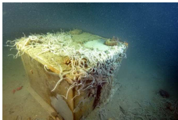
Figure 23 chambre benthique incubée pendant 10 mois. Crédit photo : Tihomir Makovec ( Metzger et al., 2014 ).
