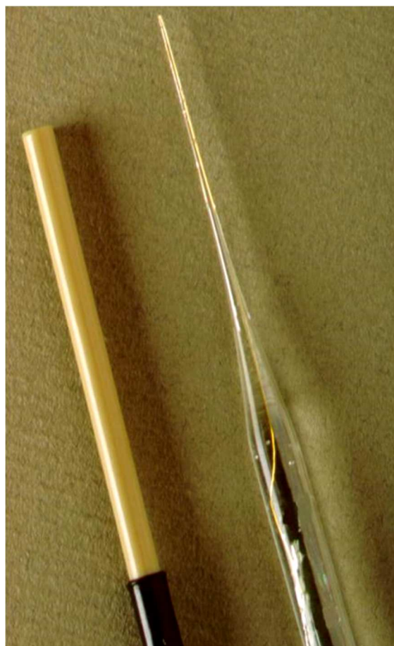
Figure 1 Microélectrodes Hg/Au : à gauche, électrode en PEEK pour des mesures temporelles ; à droite, des électrodes en verre pour profilage (Luther III et al., 2008). L'électrode de gauche à un diamètre de 3 mm.
