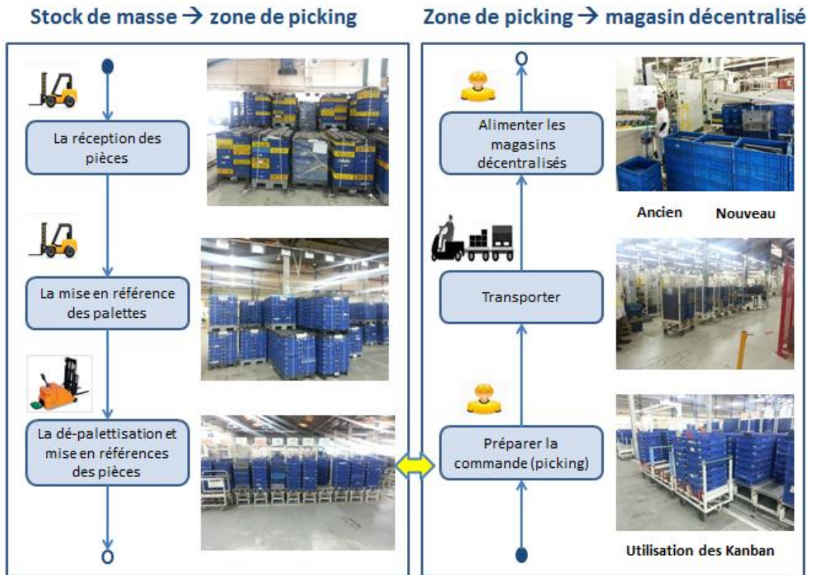
Figure 70 : flux (physique) : stock de masse → zone de picking, et Zone de picking → magasin décentralisé.
