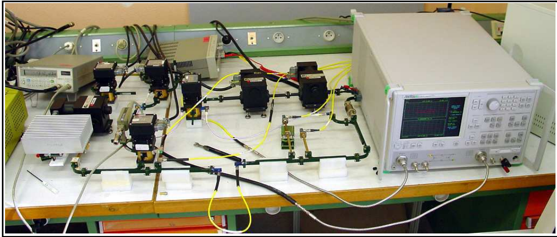
Fig. II.9 : photographie du banc avec l'ARV ANRITSU 37397C
