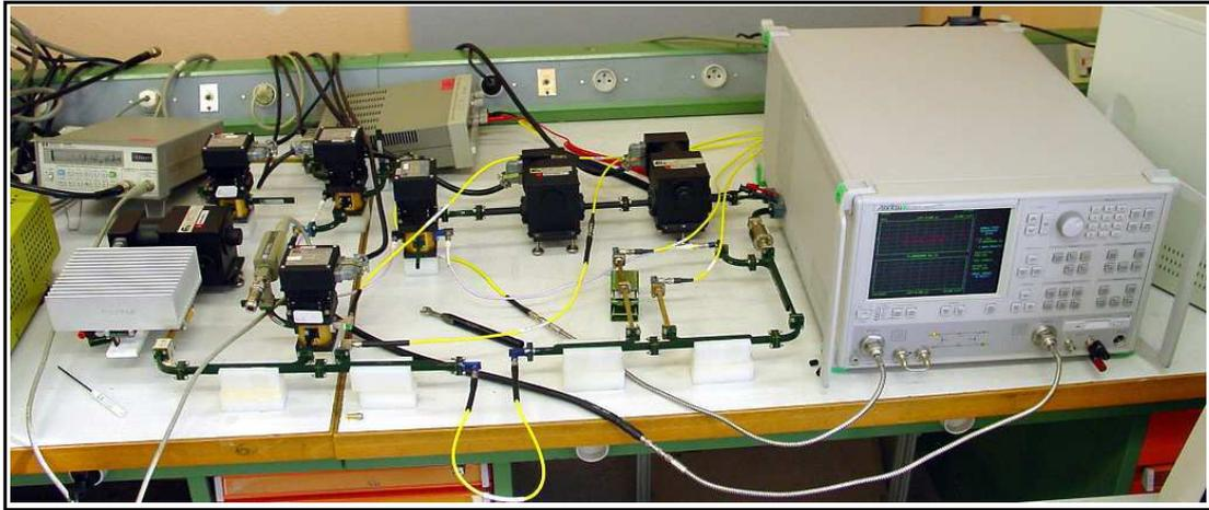
Fig. II.9 : photographie du banc avec l'ARV ANRITSU 37397C
