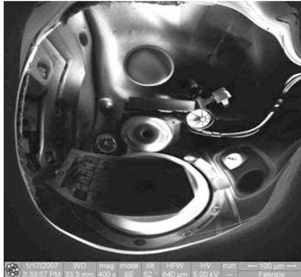
Figure 4.4 – Effet miroir ionique : d’abord un matériel isolant est chargé positivement par balayage d’un faisceau des ions à haute énergie, ensuite il est observé par balayage de faisceau des ions à basse énergie. On obtient alors une image ‘miroir’ de la chambre du microscope
