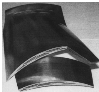
(b) Coupe de pale titane creuse
